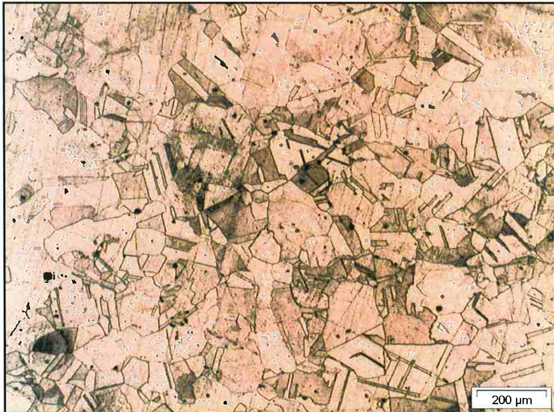
Figura 26: Aspecto dos grãos austeníticos após solubilização, ataque 10ml de H_2O , 12ml de HCL e 8ml de HNO_3
