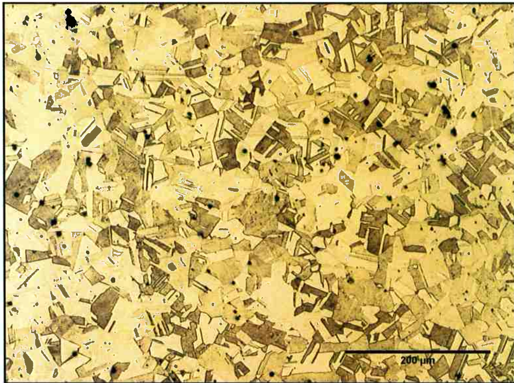
Figura 18: Aspecto dos grãos austeníticos, ataque 10ml de H 2 O, 12ml de HCL e 8ml de HNO 3 . 200X
