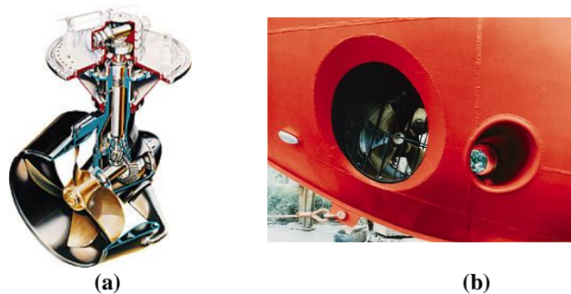
Figura 2-3 (a) Propulsor azimutal (b) Propulsor em túnel
