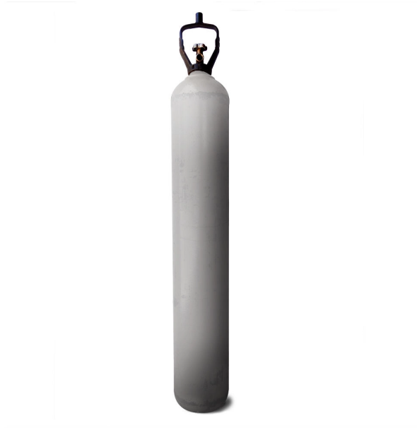
Figura 30 – Cilindro Industrial de Nitrogênio Tipo T (2631 psig, 235 Ø, 1425 mm, 61 Kg em Tara, 50L). Fonte: (Cilindro..., b)
