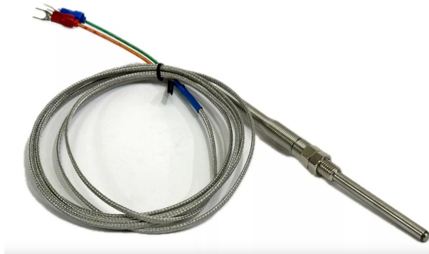
Figura 40 – Termômetro Termopar Sensor K Medição Temperatura -100 1250°C M8 50mm. Fonte: (Termopar..., )
