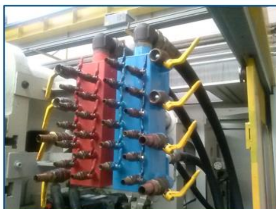
Figura 5.4 - Exemplo de melhoria de 5S realizada na célula para facilitar a identificação das mangueiras na troca de moldes.
