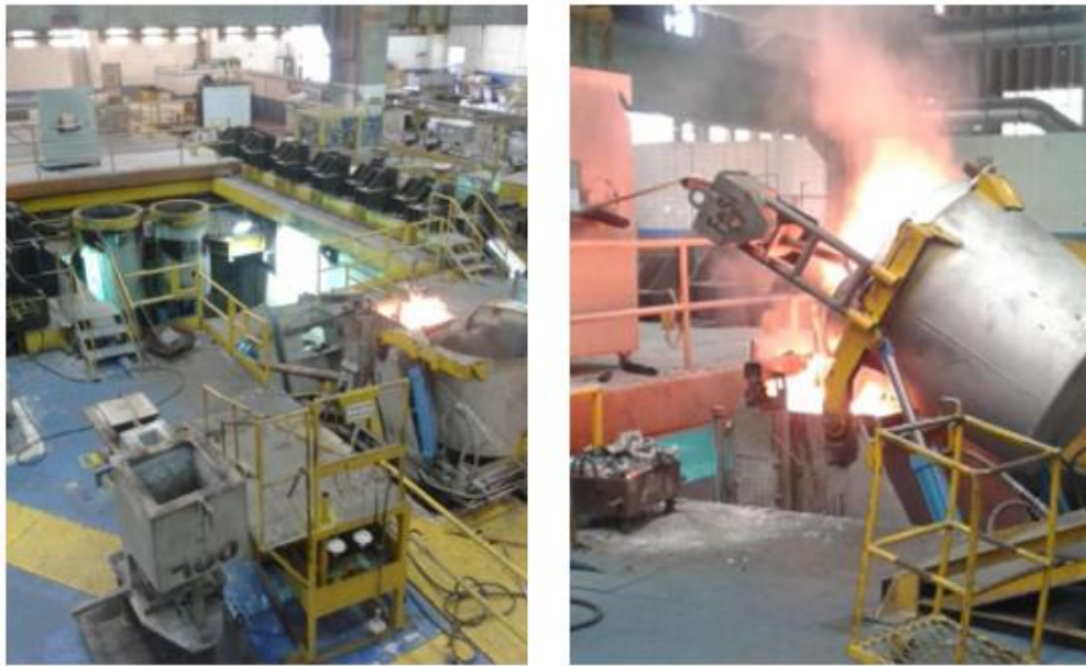
Figura 19 - Máquina centrífuga FHW (a), Vazamento do metal líquido que irá compor a casca do cilindro (b). [GERDAU. PIN-PR-715-002 - Operação da centrífuga FHW. Pindamonhangaba, 2014.] (JUNIOR, 2014).
