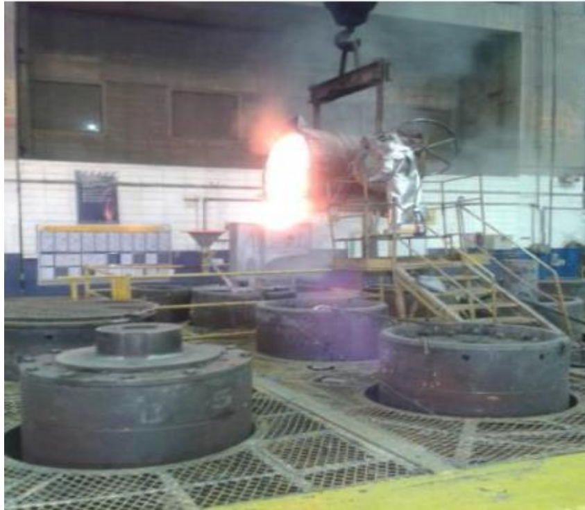
Figura 20 - Vazamento do metal líquido que irá compor o núcleo do cilindro da fossa, local onde ocorre o processo de solidificação [GERDAU. PIN-PR-715-002 - Operação da centrífuga FHW.] (JUNIOR, 2014).
