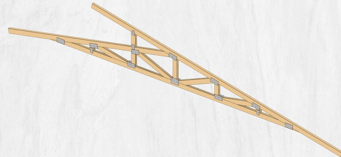
Figura 85 - Detalhamento da treliça dos blocos de wood-frame.
