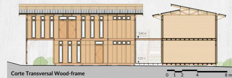
Figura 74 - Corte transversal do bloco de wood-frame.
