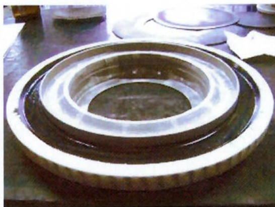
Figura 2.22 – Peça mascarada com fita e com tinta antiaderente (preta)
