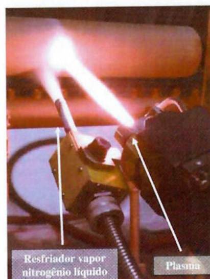
Figura 2.20 – Resfriador de vapor de nitrogênio líquido. Adaptado de SPRAYTIME [17]
