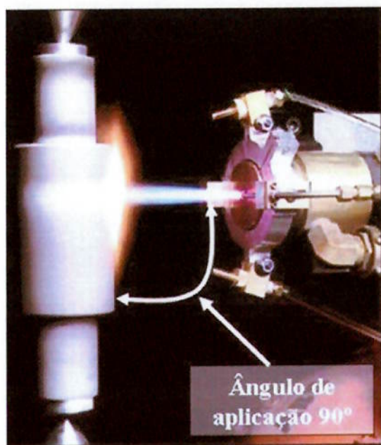
Figura 2.16 – Metalização de eixo em ângulo de aplicação de 90°. Adaptado de WONDEREN [16]
