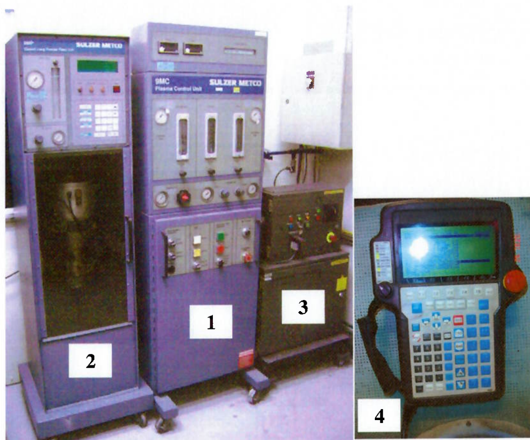
Figura 4.7 – Unidade de controle (1), alimentador de pó (2), controlador do robô (3) e teach pendant (4)
