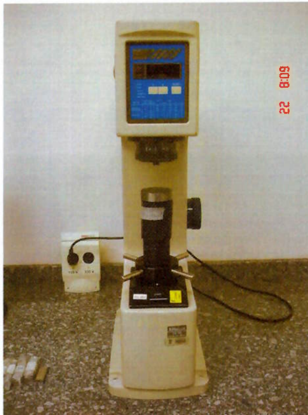
Figura 4.10 – Durômetro ATK-600 para ensaio de dureza superficial
