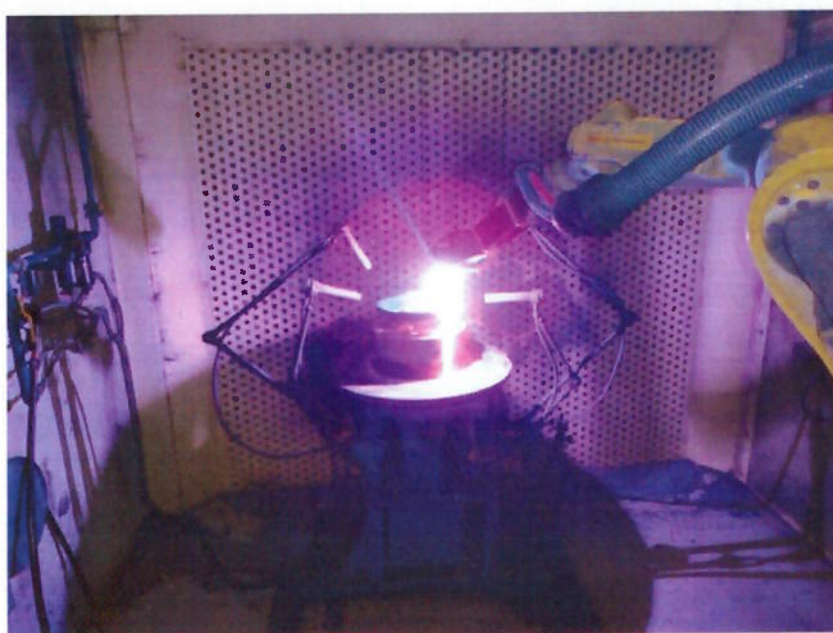
Figura 4.9 – Aplicação do pó de molibdênio nos corpos de provas
