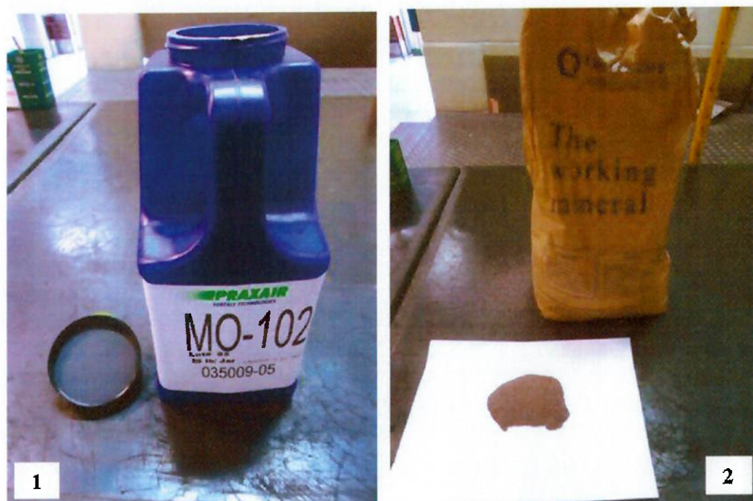
Figura 4.4 – Pó de molibdênio Praxair MO-102 (1) e óxido de alumínio grana 60 (2)
