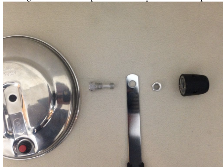
Figura 4-15 Visão explodida dos componentes da tampa
