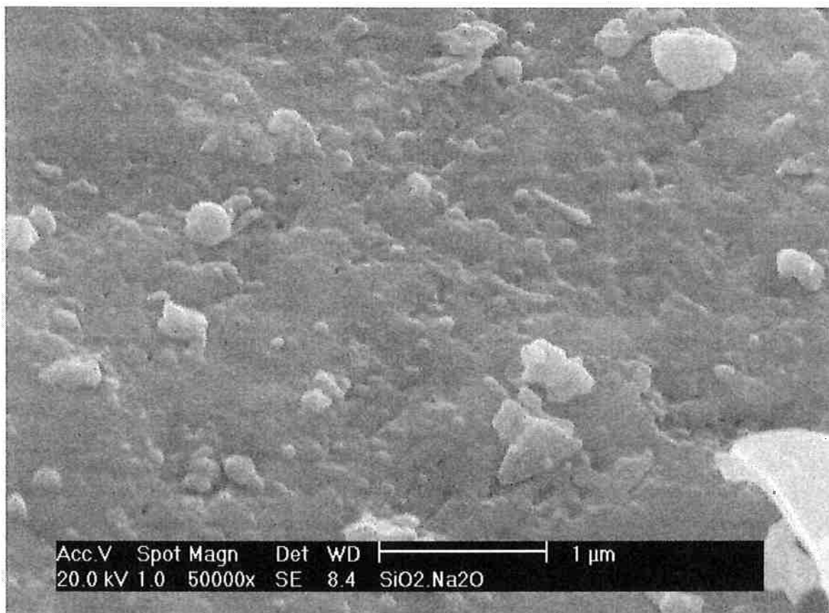
Figura 4.7.2: MEV através de elétrons secundários do briquete formado por pellet feed com silicato de sódio sinterizado a 800°C por duas horas
