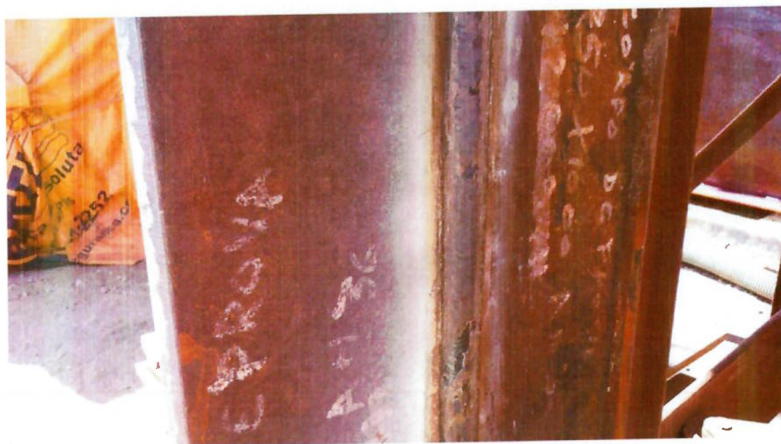
Figura 4. 5 - Visão aproximada do corpo de prova soldado com EGW.
