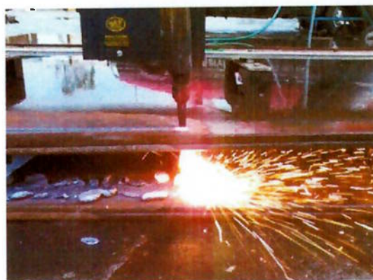
Figura 4. 1 - Preparação dos corpos de prova com oxi-corte.
