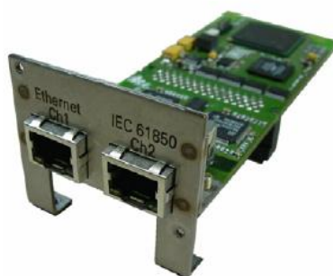
Figura 3 - Módulo de comunicação Ethernet com 2 portas - redundância - fonte: [11]
