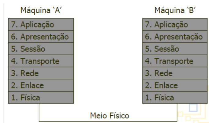
Figura 8 - Estruturação das camadas no modelo OSI - fonte: [1]
