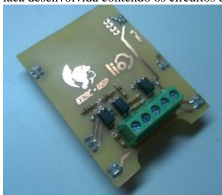
Figura 6 – Placa desenvolvida contendo os circuitos de adaptação.
