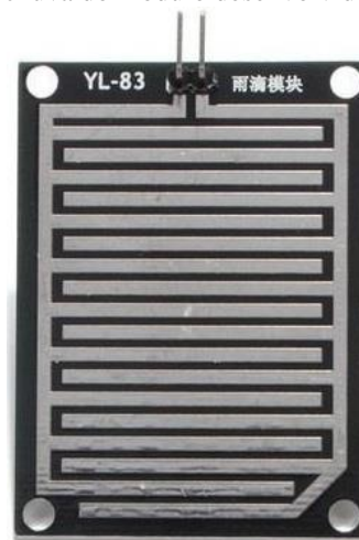
Figura 11d – Transdutor utilizado no sensor de chuva do módulo desenvolvido.
