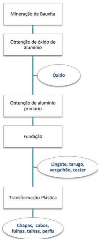
Figura 1 - Processo integrado de fabricação de alumínio
