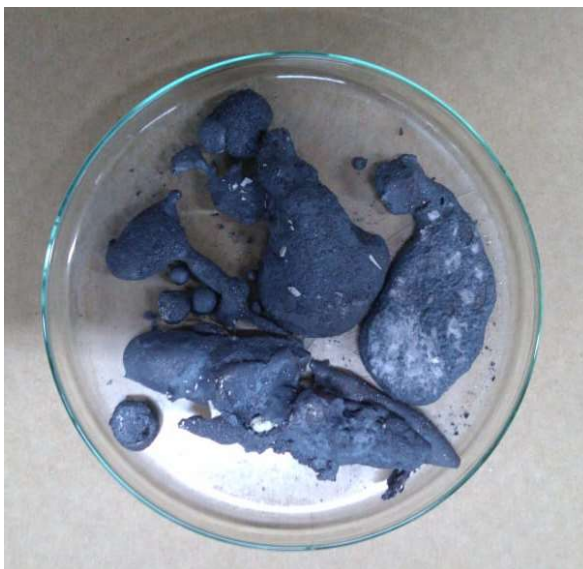
Figura 30 - Gusa após primeira experiência de dessulfuração
