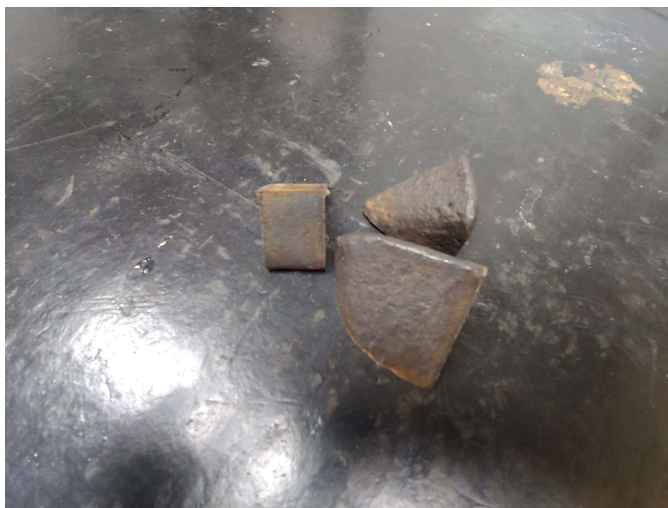
Figura 24 - Pedacos de ferro gusa a ser dessulfurado
