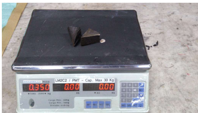
Figura 25 - Massa de gusa usado no Teste 2
