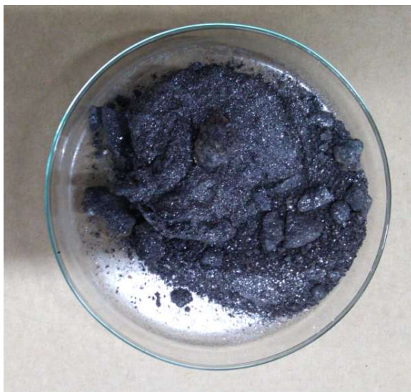
Figura 32 - Escória após experiência de dessulfuração
