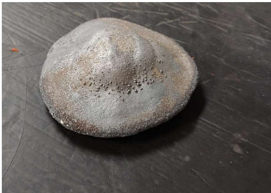
Figura 31 - Gusa após segunda experiência de dessulfuração
