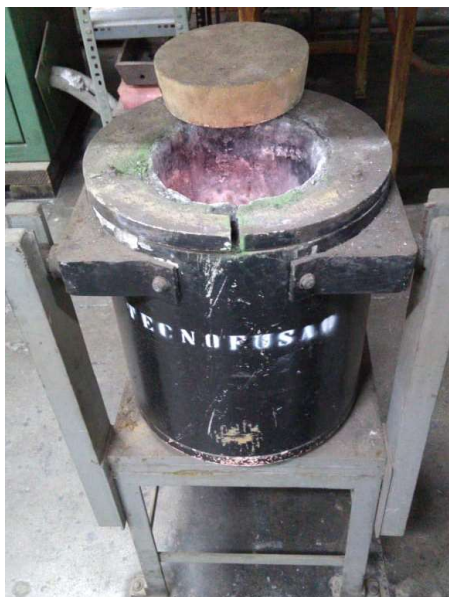
Figura 28 - Forno de indução utilizado na experiência
