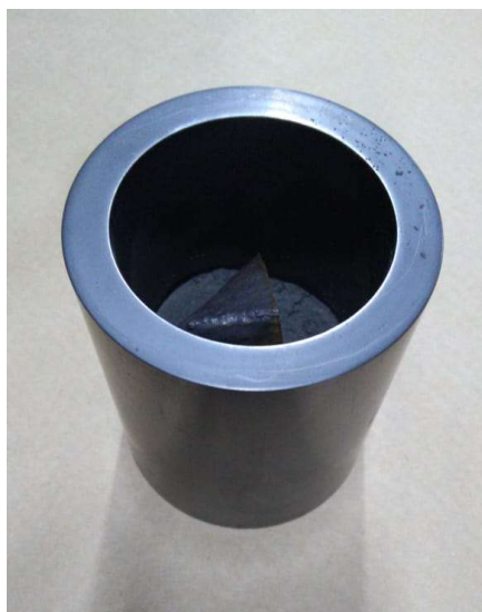
Figura 27 - Cadinho de grafita contendo a mistura dessulfurante e o ferro gusa
