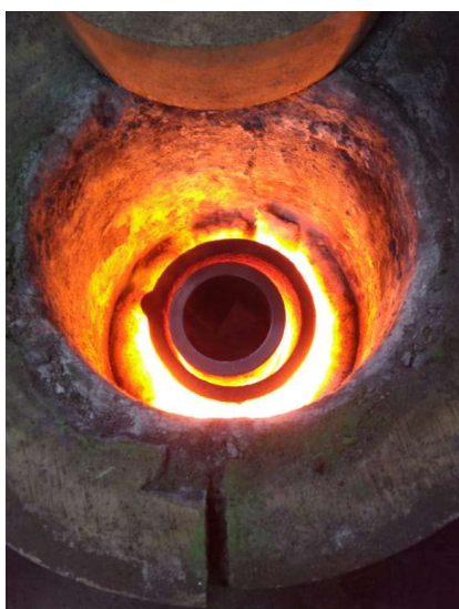
Figura 29 - Forno contendo o cadinho com gusa e a mistura dessulfurante
