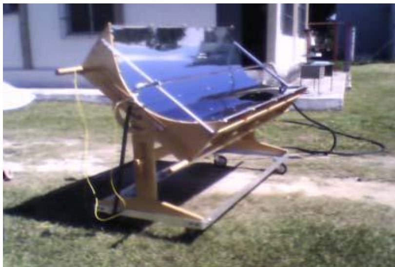
Figura 2 - Exemplo de um concentrador solar do tipo "calha" utilizado para aquecer água.
