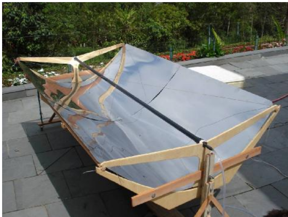
Foto 11 – Concentrador sendo ensaiado
