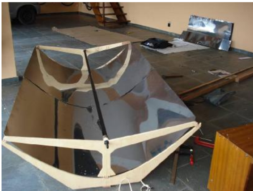
Foto 7 - Os suportes do tubo já posicionados na calha
