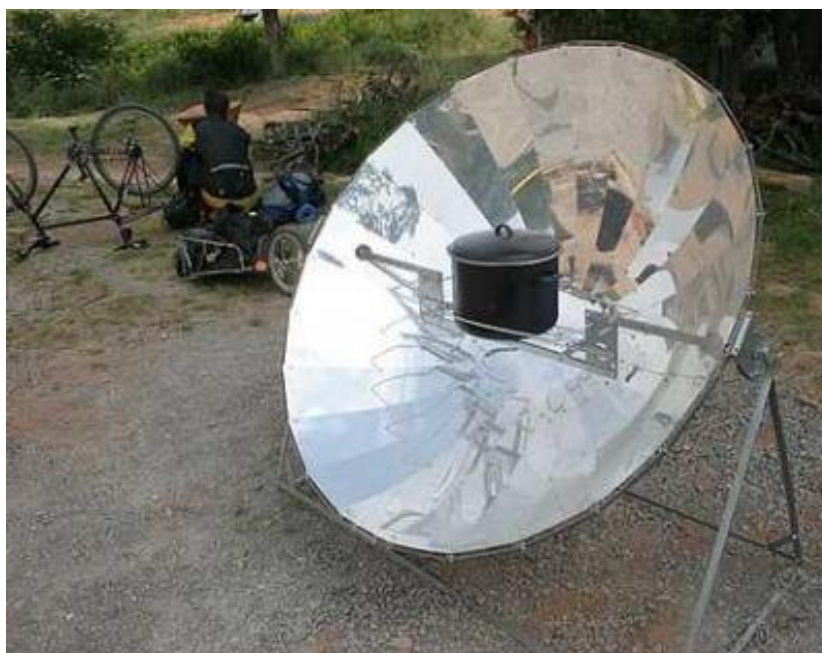
Figura 1 - Exemplo de concentrador solar do tipo "prato" utilizado para aquecer uma panela.
