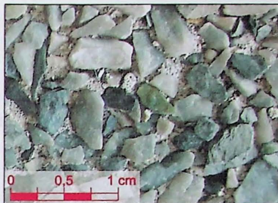
Figura 6.09. Fulget da parede externa da Capela do Hospital das Clínicas. A amostra HC-04 corresponde ao cimento entre os grãos de quartzo.
