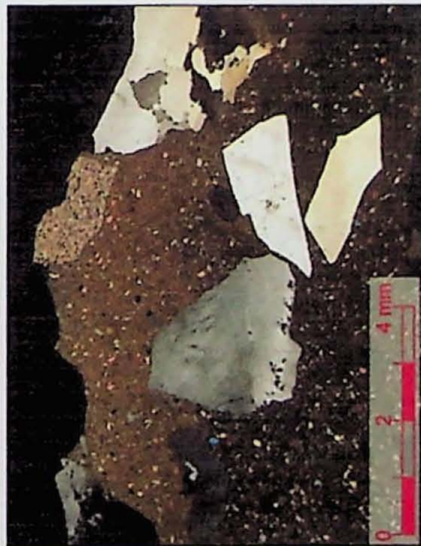
Fração grossa do agregado composta por quartzo e fragmento de rocha carbonática – polarizadores cruzados.
