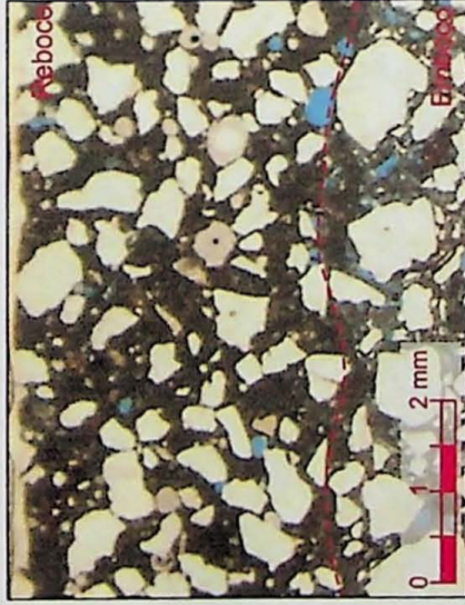
Agregado do reboco com esfericidade média. Frequentes bolhas de ar aprisionado na pasta – polarizadores descruzados.
