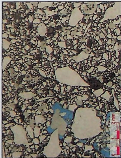
Agregado com baixa esfericidade; vazios provocados por grãos arrancados e bolhas de ar aprisionado comuns – polarizadores descruzados.
