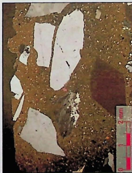
Agregado com duas frações granulométricas: fração grossa composta por quartzo – polarizadores cruzados.
