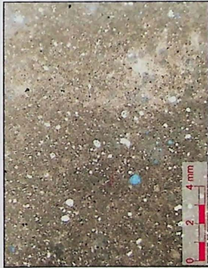
Grãos do agregado com esfericidade média, com granulometria entre 0,3 e 1,3mm – polarizadores descruzados.
