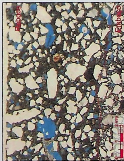
Agregado com grãos angulosos a subarredondados – polarizadores descruzados.
