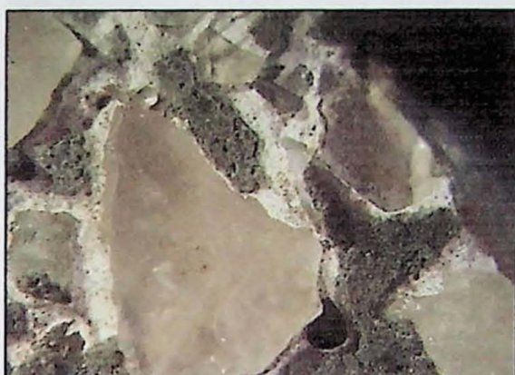
Figura 7.01. Estereomicroscopia de fulget apresentando camada de gipsita na superfície do fulget.
