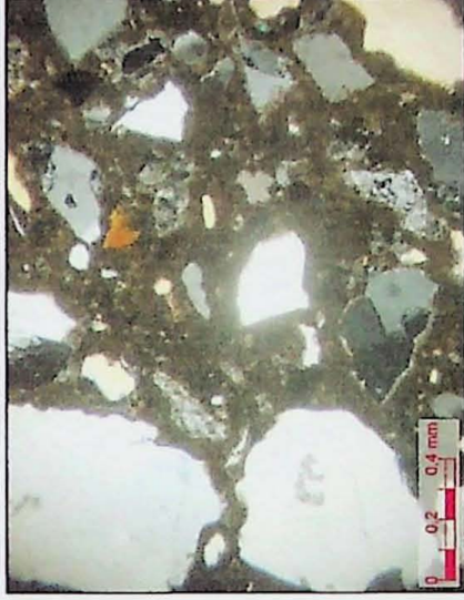
Pasta com carbonatação moderada – polarizadores cruzados.
