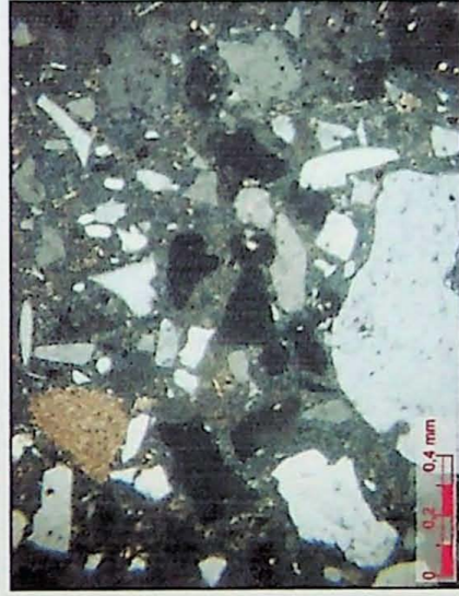
Pasta parcialmente carbonatada – polarizadores cruzados.
