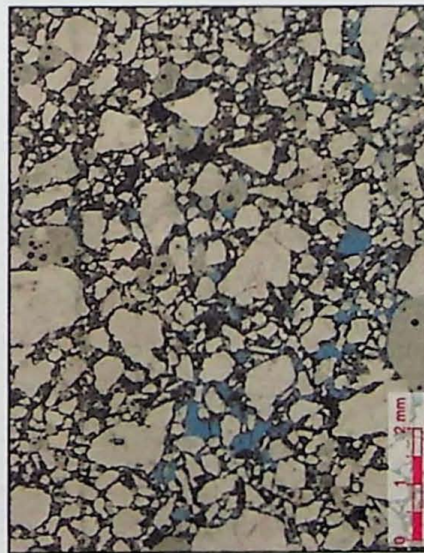
Agregado com esfericidade média e grãos subangulosos; bolhas de ar aprisionado são comuns – polarizadores descruzados.
