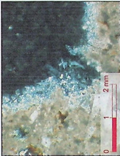
Agrupamento de cristais de gipsita na superfície do fulget – polarizadores cruzados.
