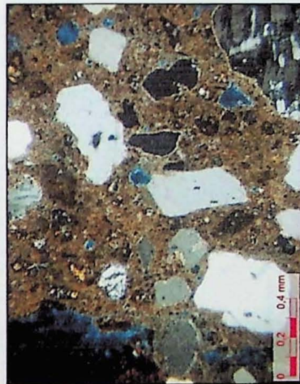
Pasta completamente carbonatada – polarizadores cruzados.
