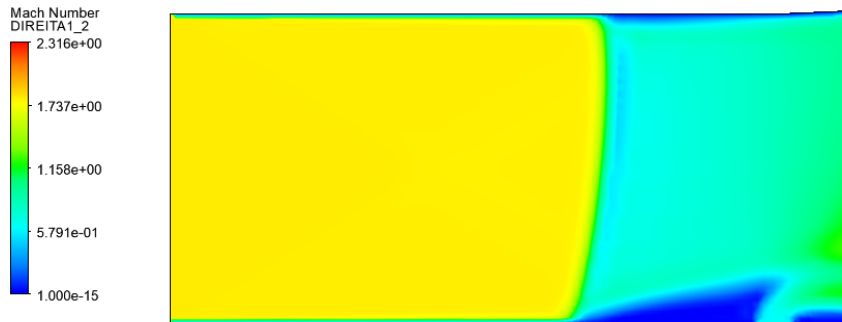
Figura 85 – Contornos de Mach na câmara de combustão para injeção a Mach 0,58 no time-step 1.433.
