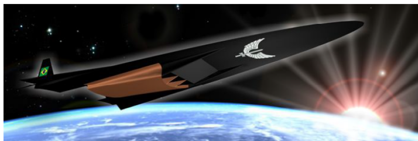
Figura 3 – Veículo hipersônico 14-X waverider . Fonte: (CARDOSO; SOUZA; TORO, 2013).
