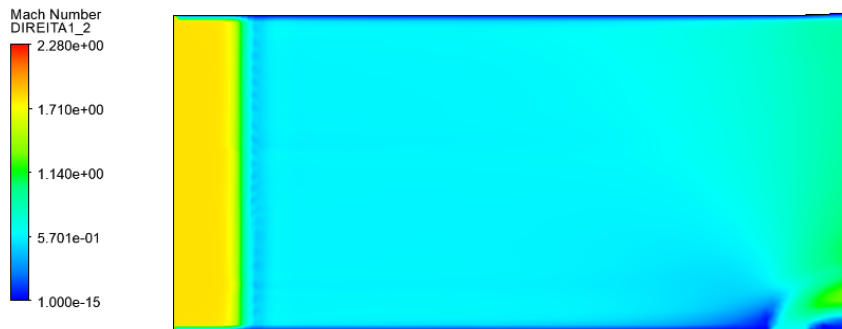
Figura 86 – Contornos de Mach na câmara de combustão para injeção a Mach 0,58 no time-step 3.170.
