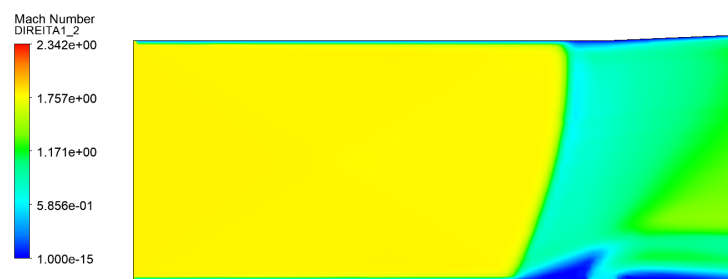
Figura 78 – Contornos de número de Mach próximos a injeção na câmara de combustão para injeção a Mach 0,54.
