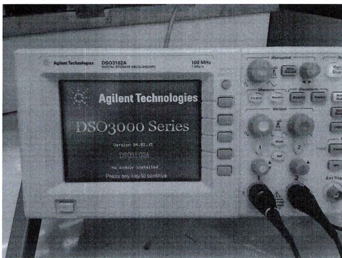
Figura 2.16 - Osciloscópio utilizado no teste de sincronização
