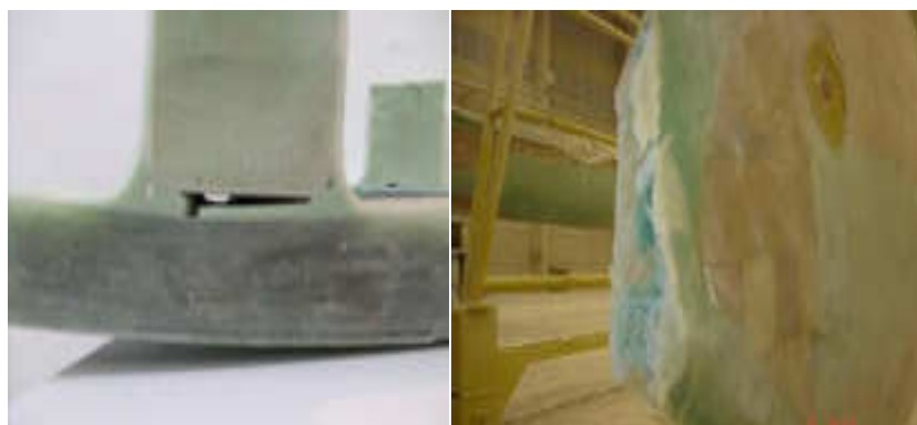
Figura 5.22: Foto caracterizando falta de colagem e ponta quebrada em pá
