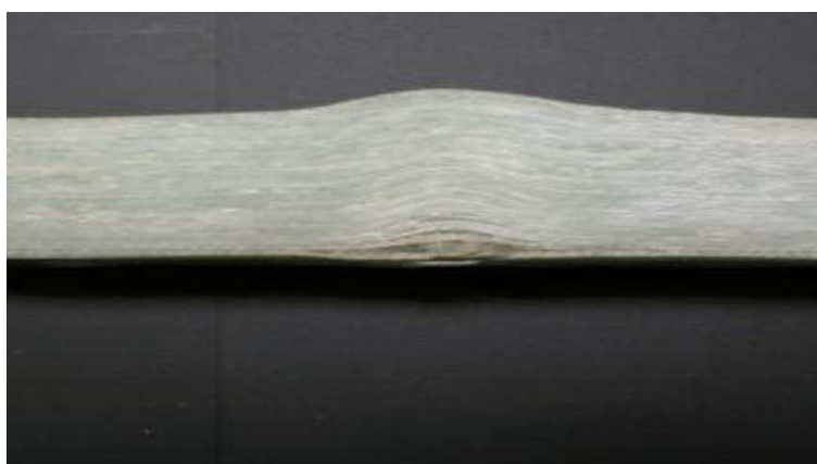
Figura 5.29: Foto caracterizando a ruptura no laminado
