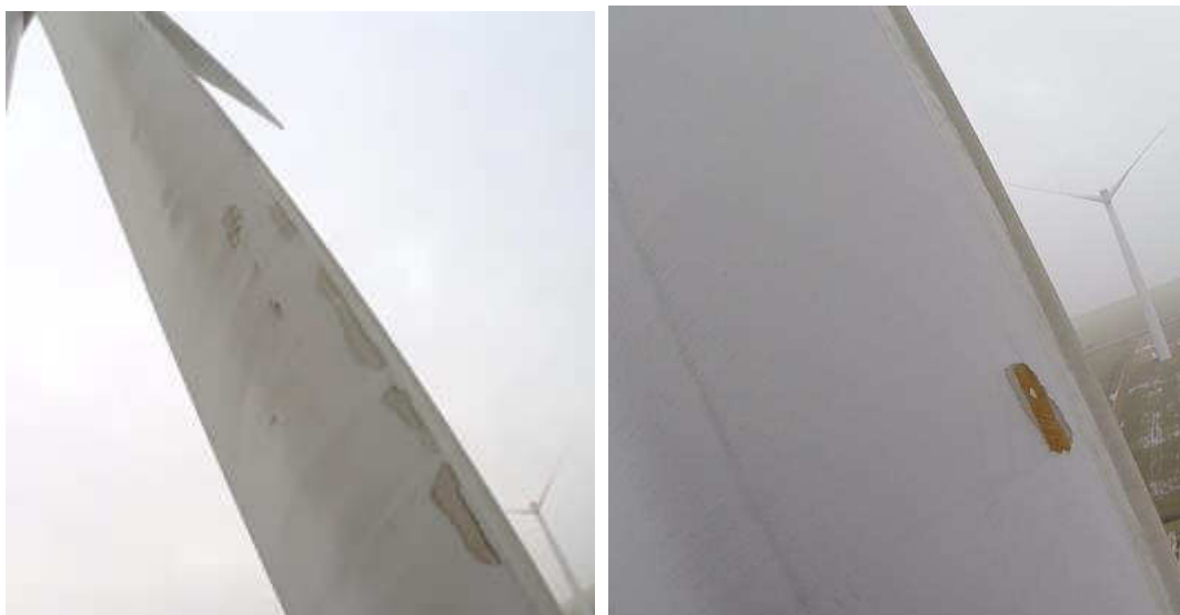
Figura 5.55: Outras falhas de delaminação nos bordos de fuga
