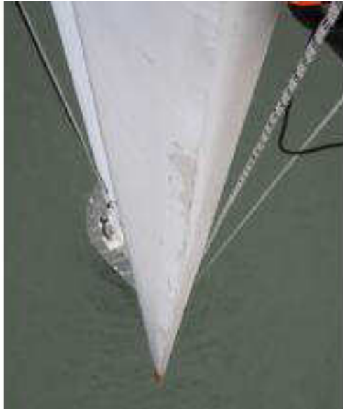
Figura 5.41: Caracterização de erosão nos bordos de ataque
