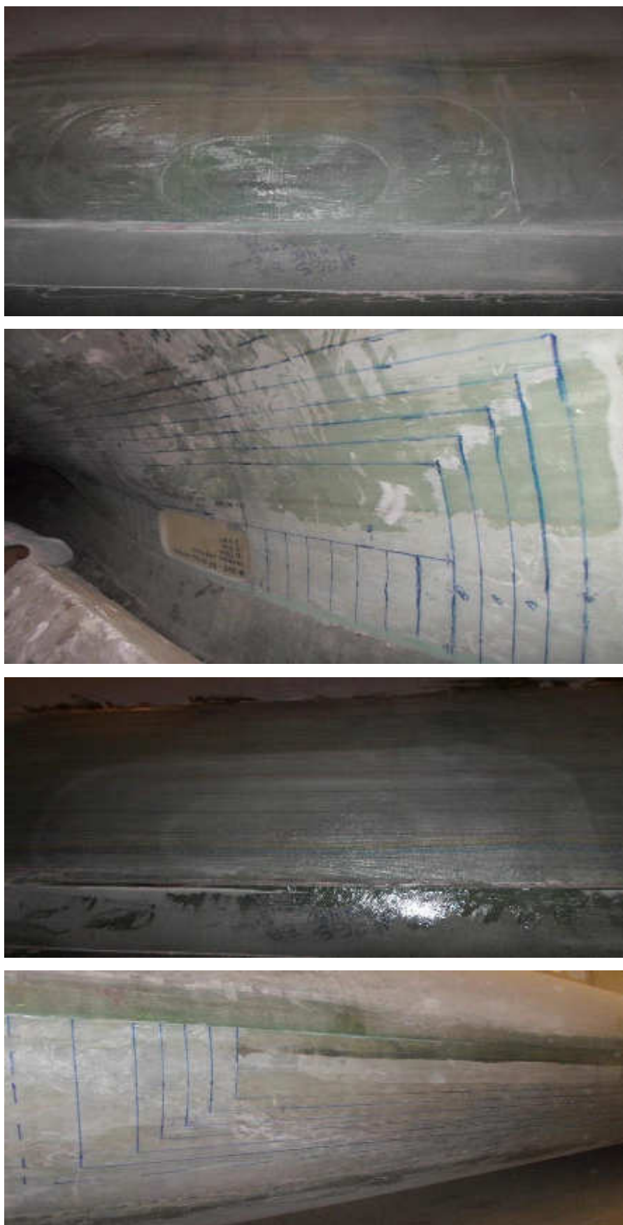
Figura 5.35: Retrabalhos diversos em estrutura interna de pás Cortesia ITW
