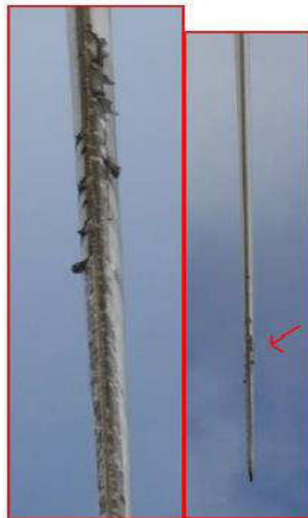
Figura 5.38: Leading edge erosion Fonte: Bladena Failure Cathalog V2_8
