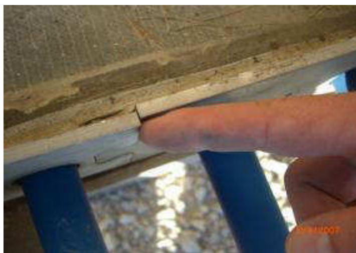
Figura 5.26: Foto caracterizando desalinhamento no molde
