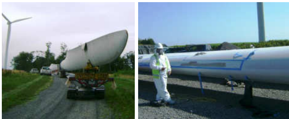
Figura 5.63: Danos causados durante o transporte
