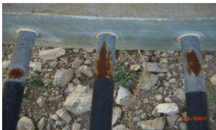
Figura 5.25: Foto caracterizando ferrugem e desalinhamento no molde
