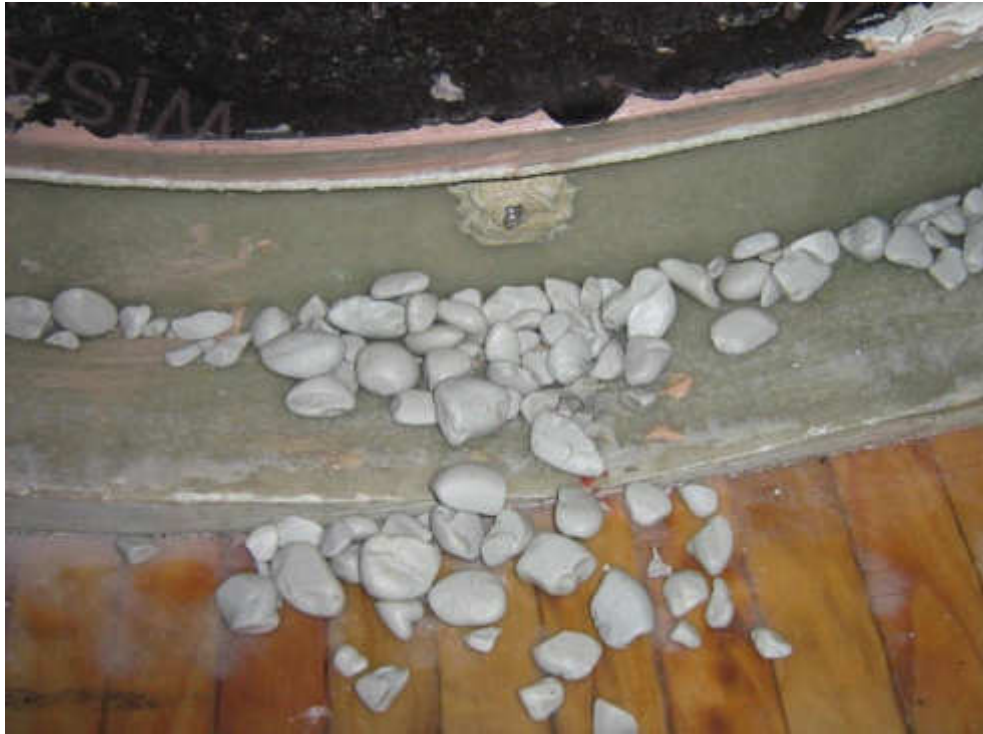
Figura 5.60: Rebarbas de colagem soltas na parte interna
