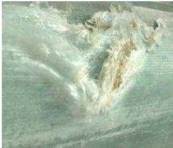
Figura 5.17: Foto caracterizando uma Delaminação na pá
