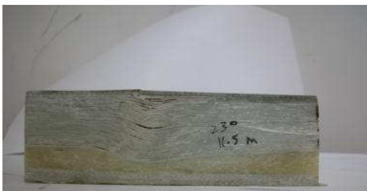
Figura 5.28: Foto caracterizando a ruptura no laminado
