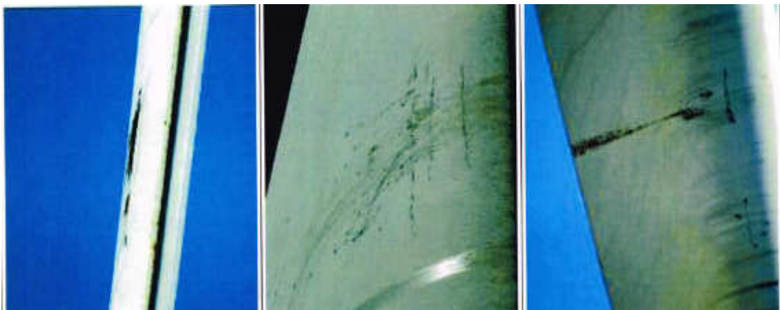
Figura 5.61: a, b, c respectivamente, mostra consequências do impacto físico de objetos estranhos, tais como aves e insetos por exemplo.
