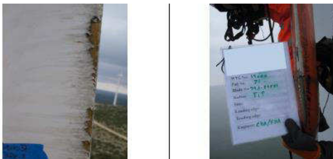
Figura 5.40: Erosão nos bordos de ataque
