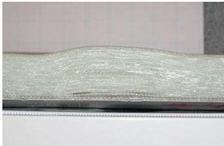
Figura 5.20: Foto caracterizando falta de compactação no laminado da pá
