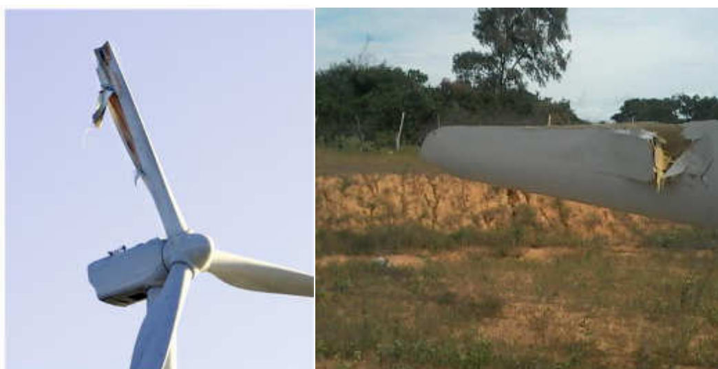
Figura 5.59: Rompimento de pás sujeitas a intempéries no campo
