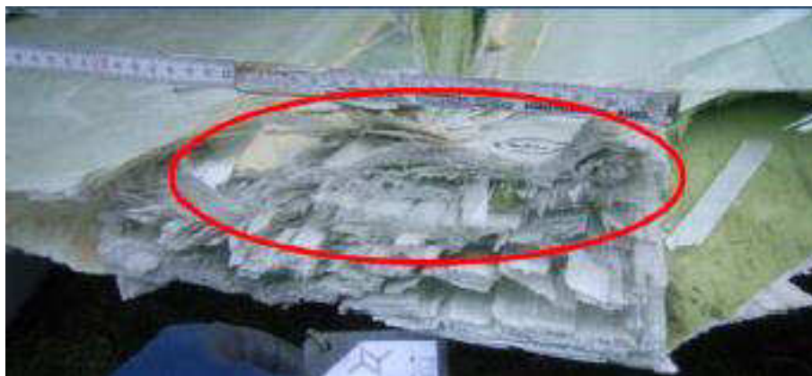
Figura 5.57: Pá apresentando rompimento estrutural
