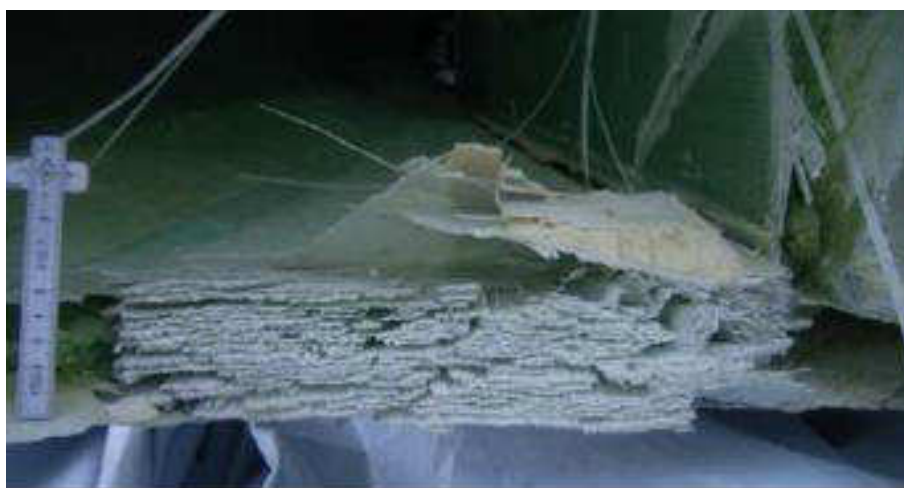
Figura 5.58: Pá apresentando rompimento estrutural
