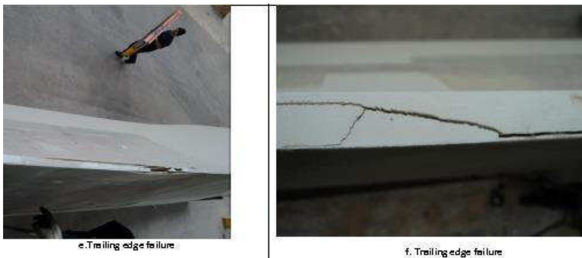
Figura 5.51: Trinca longitudinal nos bordos de fuga
