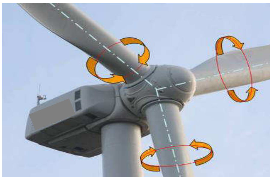
Figura 3.9: Rotação das pás para "Pitch Control"
