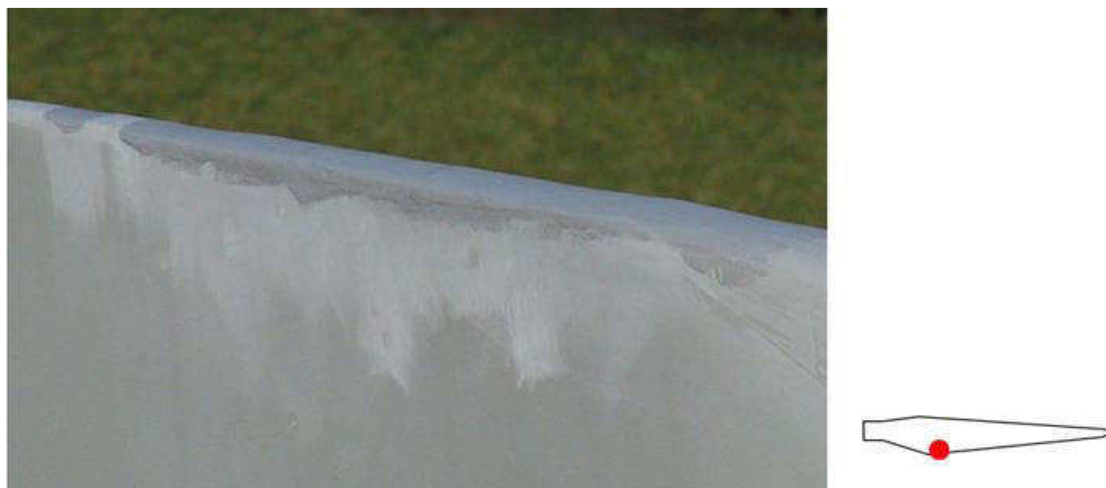
Figura 5.43: Bordo de ataque desgastado pela erosão
