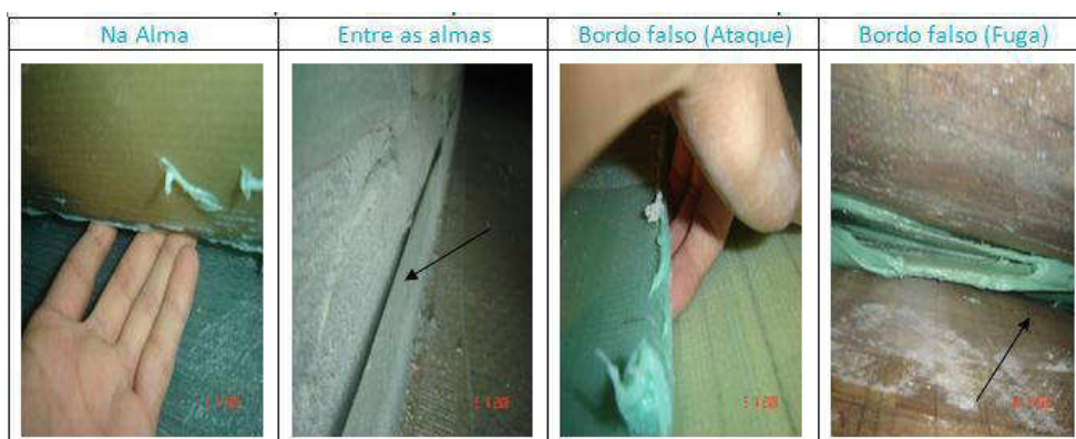
Figura 5.23: Fotos caracterizando falha de massa no processo de colagem
