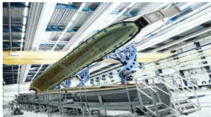
Figura 5.3: Fechamento de um molde de infusão
