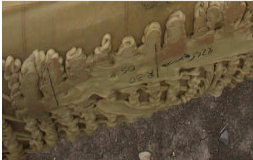
Figura 5.33: Falta de material adesivo entre a caixa estrutural e as cascas de formato aerodinâmico
