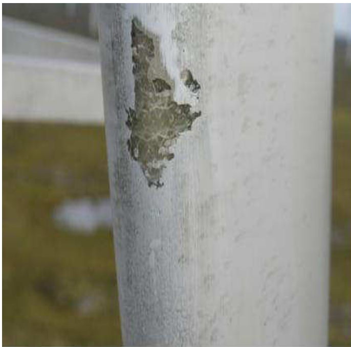
Figura 5.42: Descascamento de laminado ( Epoxi )
