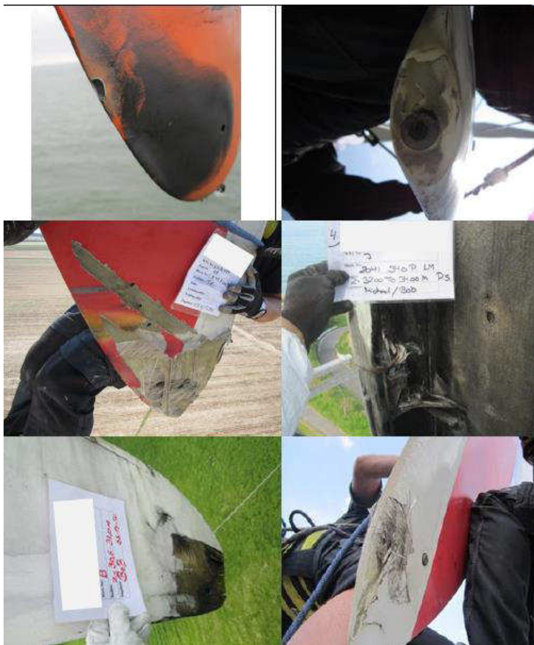
Figura 5.49: Pontas de Pás diversas que sofreram descargas elétricas
