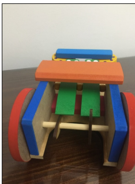
Figura 95: Traseira do carrinho com sistema de transmissão de movimento (Fonte: autoria própria)
