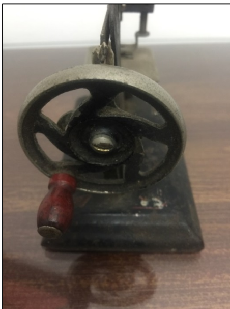
Figura 50: Manivela de máquina de costura antiga (Fonte: autoria própria)
