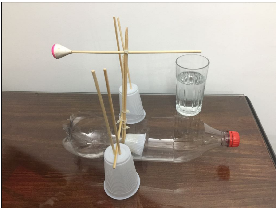
Figura 90: Monjolo sem retorno do pilão na posição original (Fonte: autoria própria)
