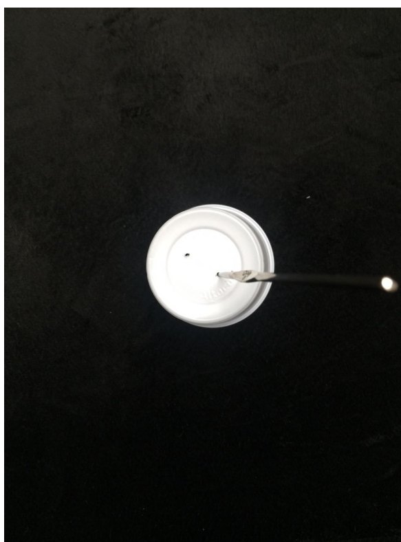
Figura 87: Agulha de crochê quente para furar a torre (Fonte: autoria própria)
