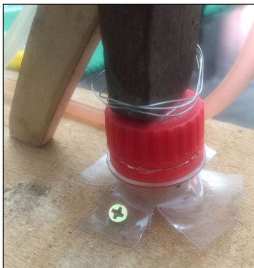
Figura 63: Fixação da torre em bucal de garrafa para movimentação lateral
