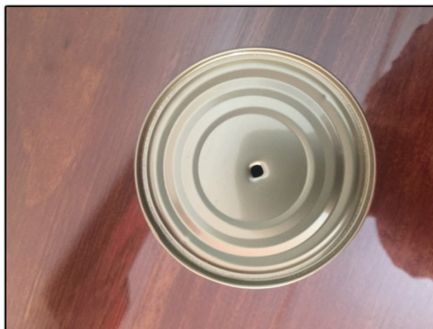
Figura 20: Lata após a furação (Fonte: autoria própria)
