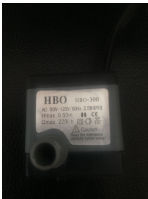
Figura 72: Bomba HBO 300 (Fonte: autoria própria)
