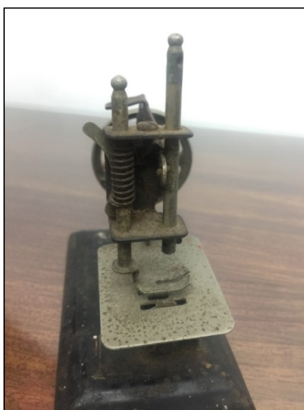
Figura 51: Pino de fixação da agulha em sua posição totalmente levantada (Fonte: autoria própria)
