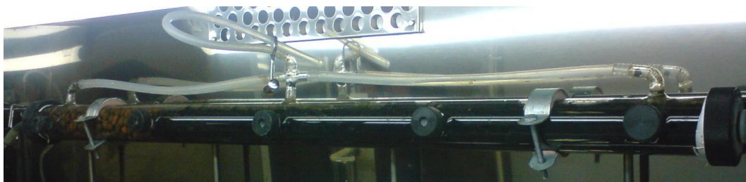
Figura 4. 2- Reator anaeróbico horizontal de leito fixo instalado em câmara de controle de temperatura.
