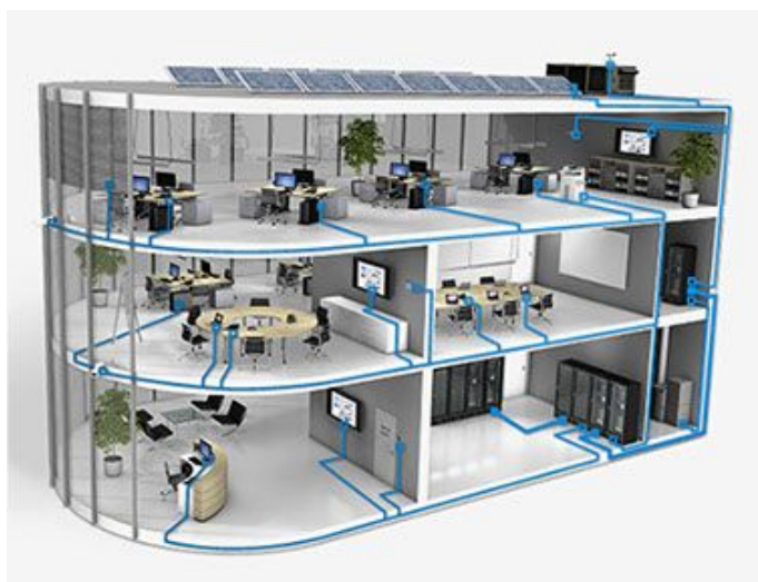
Figura 08 - Esquemático de um projeto de cabeamento estruturado para automação.
