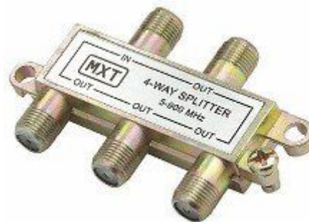
Figura 04 - Splitter de cabo coaxial.
