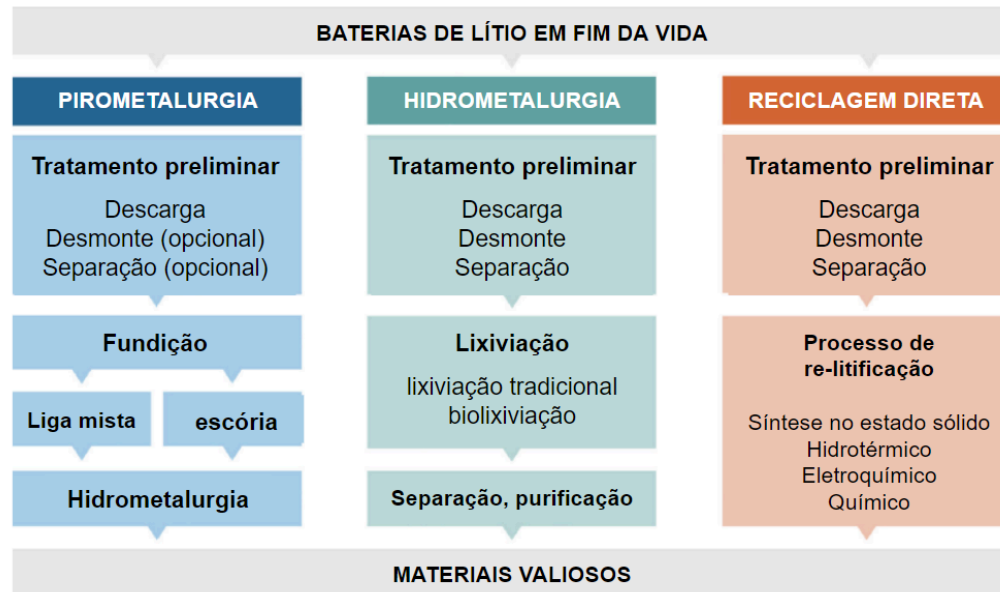
Figura 31: Resumo das rotas de reciclagem de baterias de lítio
