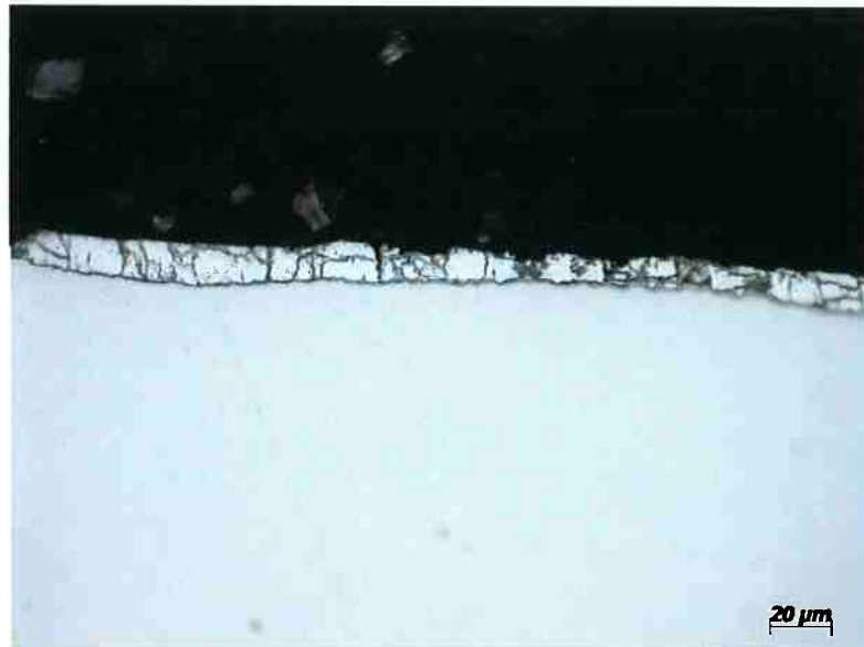
Figura 21: Chapa GA atacada. Aumento de 500\times^{[15]} .
