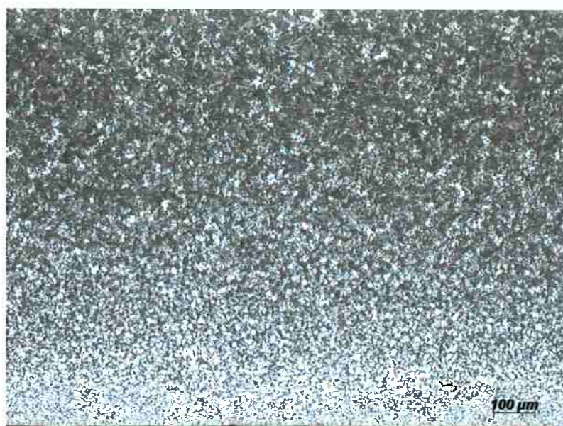
Figura 30: Detalhe micrográfico da região termicamente afetada da chapa revestida com GI. Tamanho de grão de 7 a 8 conforme ASTM [16] .
