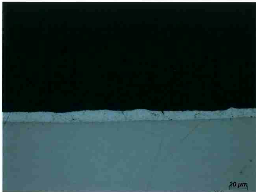
Figura 18: Chapa GI sem ataque. Aumento de 500X [15] .
