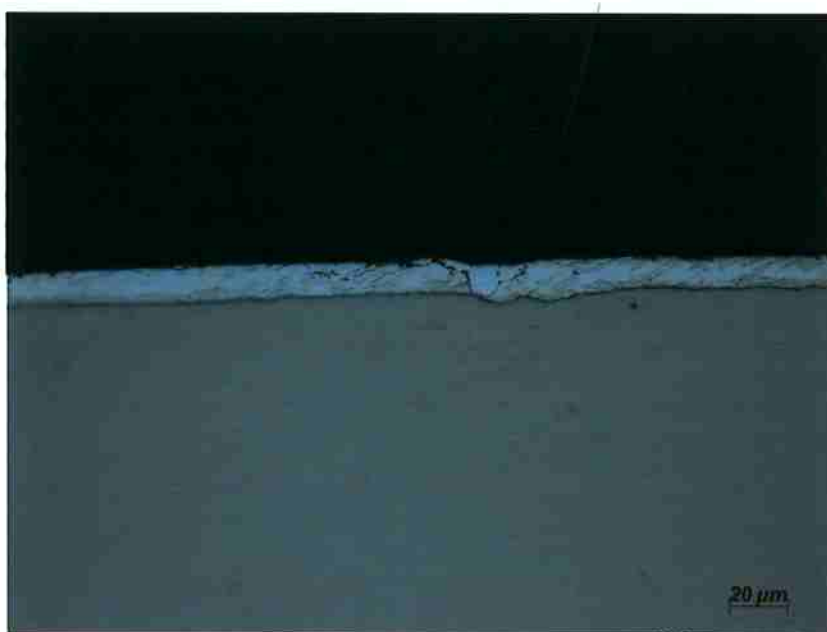
Figura 23: Chapa GI atacada. Aumento 500X [15] .
