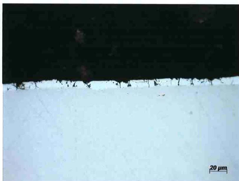
Figura 17: Chapa GA sem ataque [15] .
