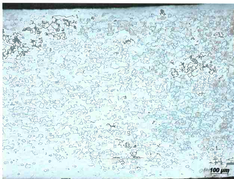
Figura 27: Detalhe micrográfico do núcleo da chapa revestida com GA, em uma região que não sofreu mudanças com a variação de temperatura da solda ponto. Tamanho de grão de 7 a 8 conforme ASTM [16] .
