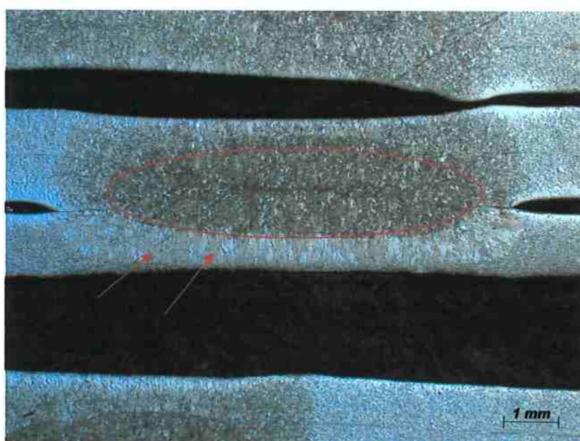
Figura 32: Solda ponto C1 nas chapas 1mm (GA – a de baixo) e 1,5mm (GI – a de cima), utilizando o programa de solda 1. Na região indicada pelo círculo temos uma zona fundida. Logo abaixo desta zona vê-se uma região de grãos grandes que cresceram em cima da fase sólida (setas), já que esta região chegou a temperaturas próximas a de austenitização [16] .
