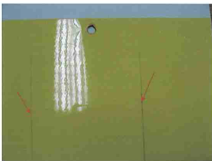
Figura 42: Chapa zincada EGP apresentando corrosão apenas na região do corte [15] .
