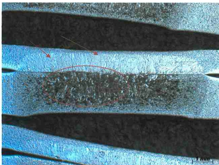
Figura 35: Solda ponto D2 nas chapas 1mm (GA – a de cima) e 1,7mm (GI – a de baixo), utilizando o programa de solda 2. Nesta figura vê-se uma grande zona de grãos colunares (região indicada por setas), em detrimento de um pequena região fundida (região indicada pelo círculo) [16] .
