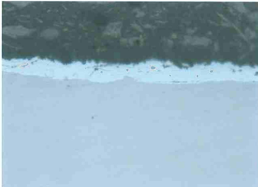
Figura 20: Detalhe da chapa EGP sem ataque. Aumento de 1600\times^{[15]} .
