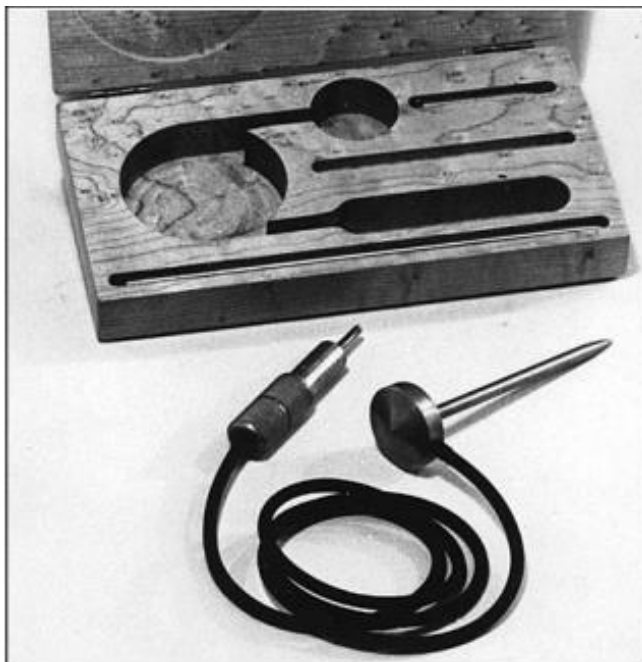
Figura 1: Acelerômetro B&K Modelo 4303 – provável primeiro acelerômetro comercial piezoelétrico (~1945 - ~1948). [2]
