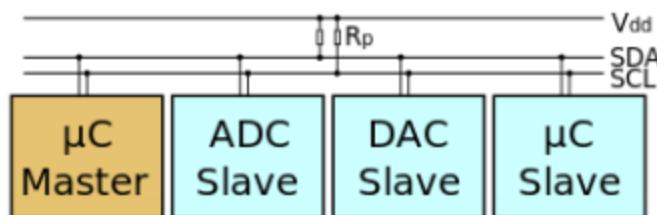
Figura 5: Configuração da estrutura do protocolo de comunicação I2C [13].
