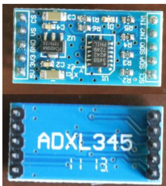
Figura 8: Configuração dos pinos do ADXL345 [16].
