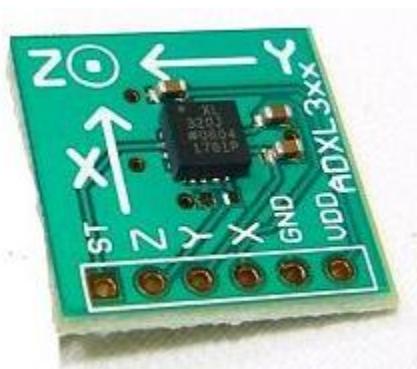
Figura 2: Exemplo de um acelerômetro MEMS. [18]
