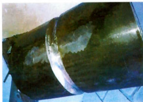
Figura 4.3 – Corpo de prova de aço API 5L X65 com a junta parcialmente preenchida.
