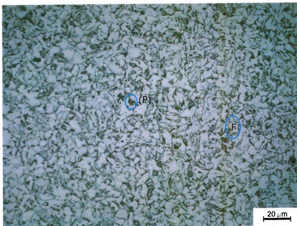
Figura 5.9 – Micrografia do metal de base do tubo API 5L X65. Ataque Nital 2%. Perlita (P) e Ferrita (F). Aumento 500X.
