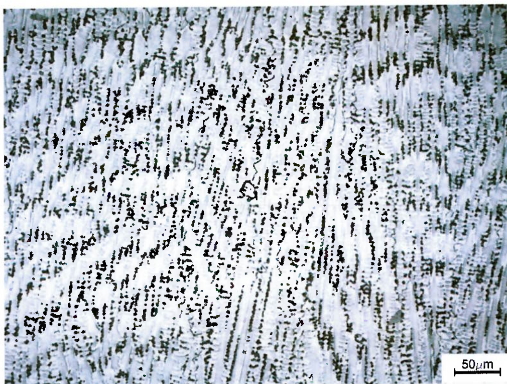
Figura 5.10 – Micrografia do Inconel® 625 utilizado para o revestimento interno do tubo API 5L X65. Matriz austenítica e segregações do último líquido a solidificar na cor preta. Ataque ácido Crômico 10%. Aumento 200X.
