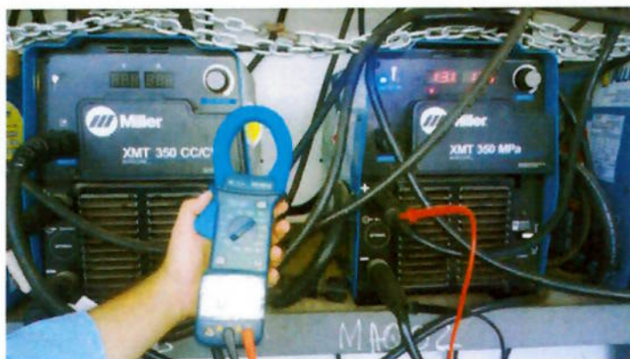
Figura 4.4 – Controle da corrente e da tensão durante a soldagem do corpo de prova.
