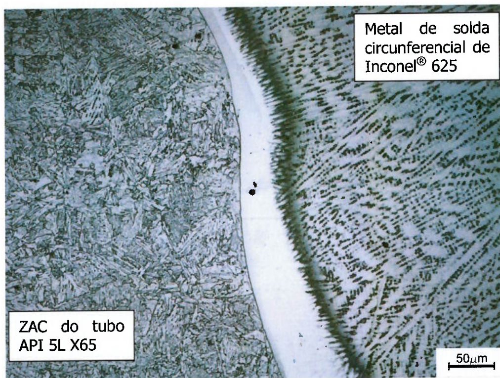
Figura 5.16 – Micrografia da região de transição da ZAC do tubo API 5L X65 e do metal de solda circunferencial. Ataque Nital 2% (API 5L X65) e o ataque ácido Crômico 10% (Inconel® 625).
