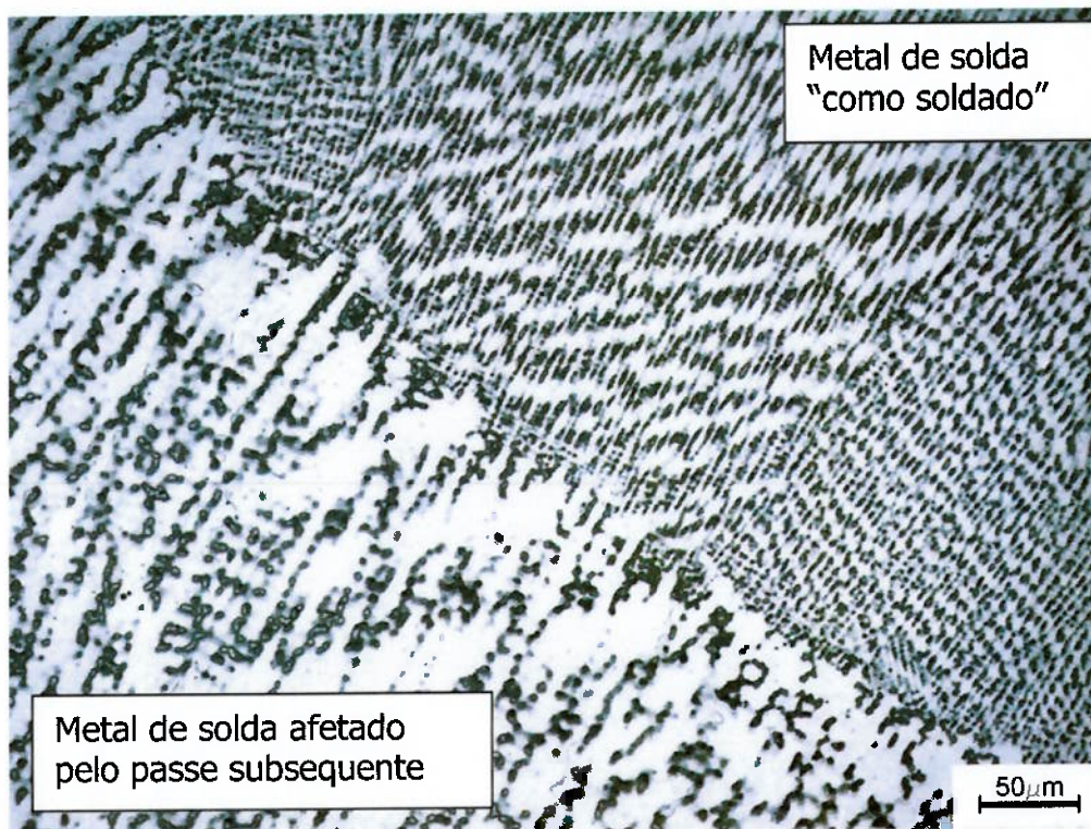
Figura 5.18 – Micrografia do Inconel® 625 no metal de solda circunferencial mostrando o metal de solda como soldado e o metal de solda afetado pelo passe subsequente. Matriz austenítica e segregações do último líquido a solidificar na cor preta. Ataque ácido Crômico 10%..
