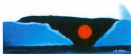
Figura 4.9 – Região na junta soldada onde foi feita a medição.
