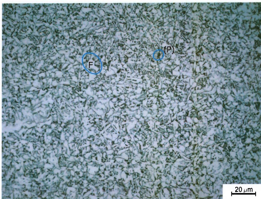
Figura 5.13 – Micrografia da ZAC do tubo API 5L X65 causada pela soldagem circunferencial. Região com ferrita (F) e perlita (P). Ataque Nital 2%. Aumento 500X.
