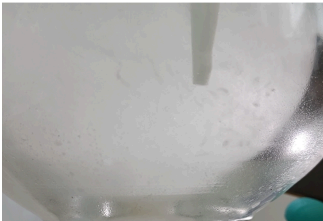
Figura 7. Dissolução de um sal em água num tanque agitado com N = 900 rpm. Os sólidos estão em suspensão e uniformemente distribuídos.
