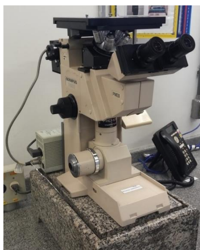
Figura 25 - Microscópio óptico utilizado para observação da microestrutura.
