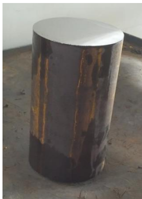
Figura 8 - Exemplo de billet cortado para operação de forjamento.
