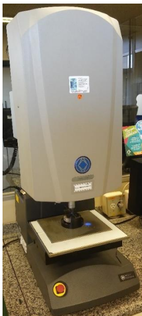
Figura 24 - Microdurômetro utilizado para medição da profundidade de camada.
