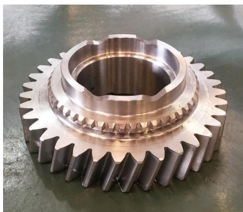
Figura 11 - Exemplo de engrenagem após o processo de fabricação dos dentes.
