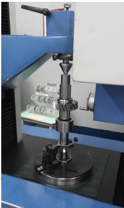
Figura 21 - Dispositivo de medição de forma geométrica
