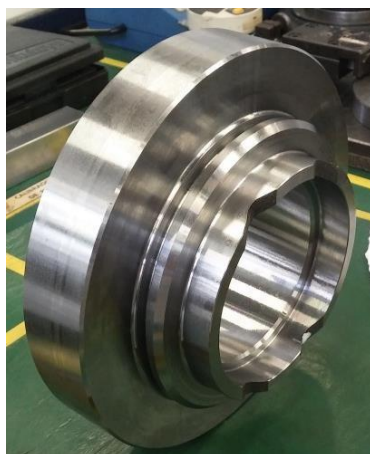
Figura 10 - Exemplo de engrenagem após o processo de torneamento.
