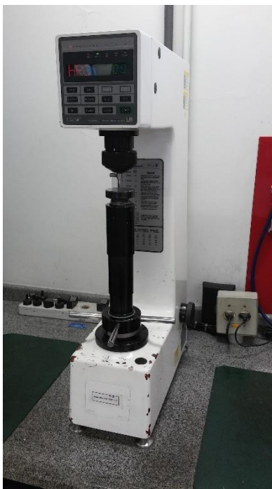
Figura 27 - Durômetro utilizado para medição da dureza superficial e de núcleo.
