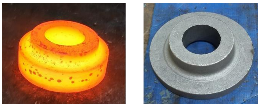
Figura 9 - Exemplo de engrenagens a) logo após o forjamento b) após o processo de normalização e jateamento.
