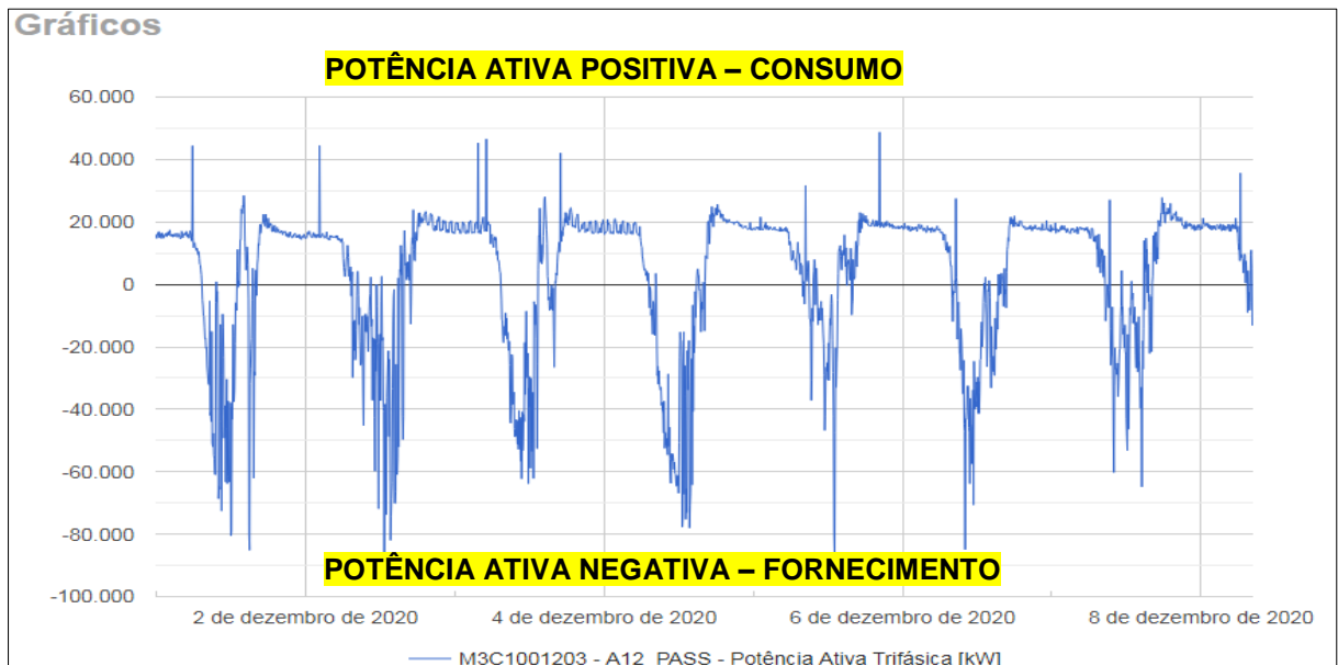
Figura 21 – Histórico da demanda de potência ativa trifásica.
