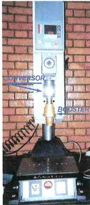
Figura 2.4 - Imagem do posicionamento do conversor e do booster em um equipamento de soldagem por ultra-som Branson 920.
