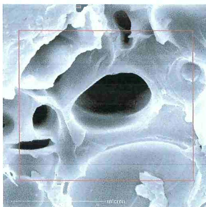
Figura 5.15e – MEV ( x2320 ) Descontinuidade no material
