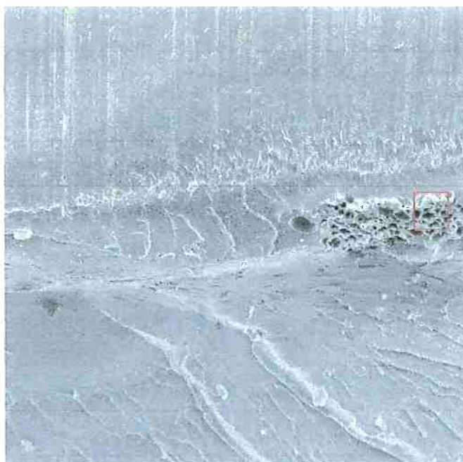
Figura 5.15d – MEV ( x130 ) Extremidade da região soldada
