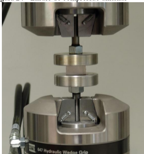
Figura 24 - Ensaio de compressão uniaxial
