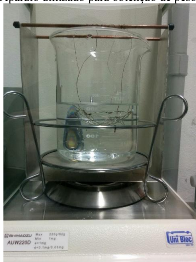
Figura 13 – Aparato utilizado para obtenção de peso imerso.
