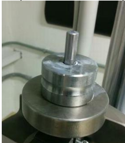
Figura 20 - Cilindro e pistão utilizados no ensaio de compressão confinada
