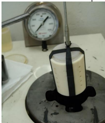
Figura 14 – Molde sendo introduzido na prensa isostática
