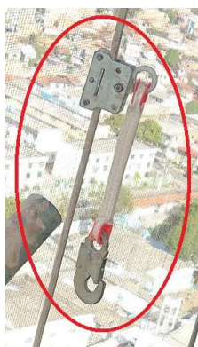
Figura 22: Dispositivo trava-quedas. Fonte: Arquivo pessoal.
