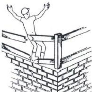
Figura14: Falha do EPC. Fonte: Roque, 2011.
