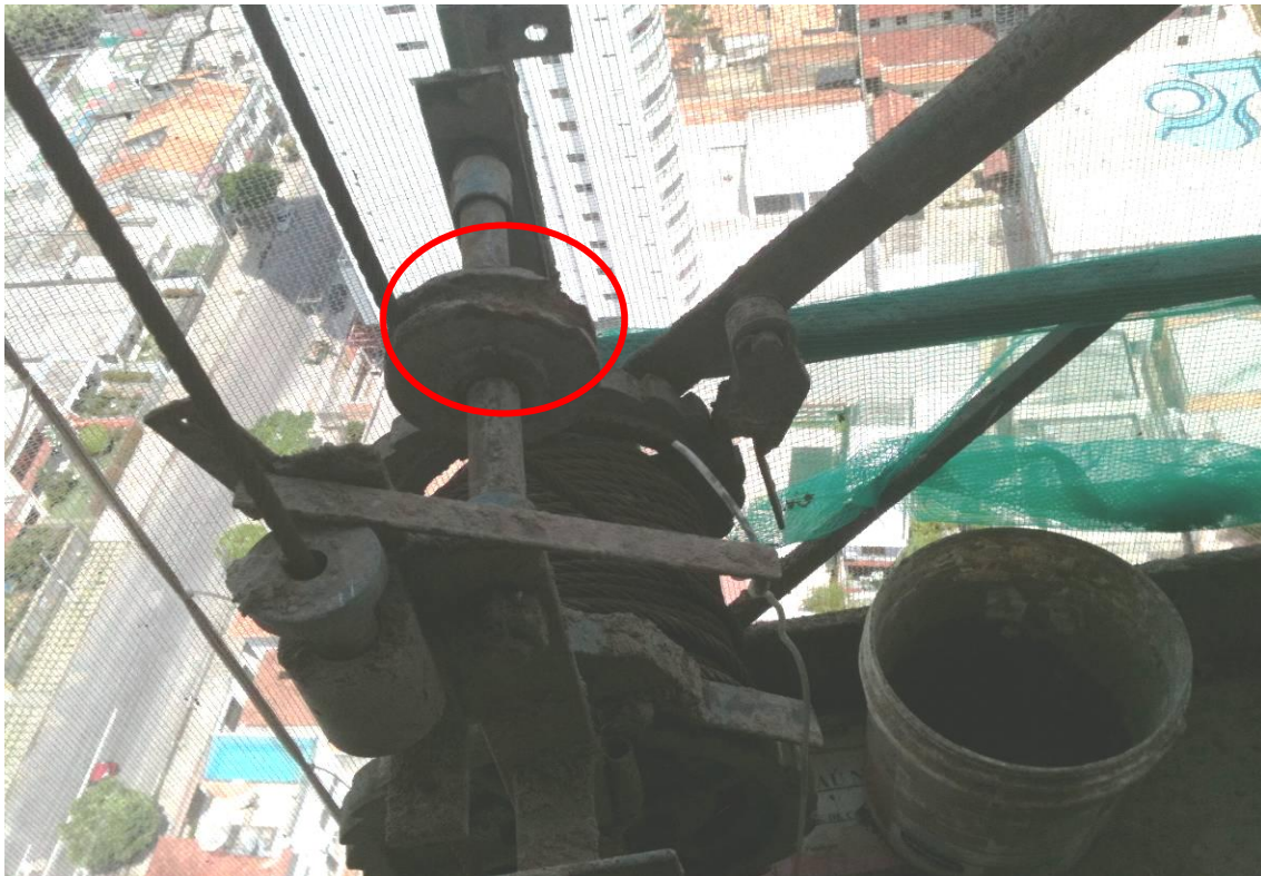
Figura 32: Roldana deteriorada. Fonte: Arquivo pessoal.
