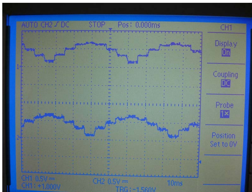
Figura 4.10 – Gráfico de sinais de tensão de referência para modo micropasso 1/4 passo.
