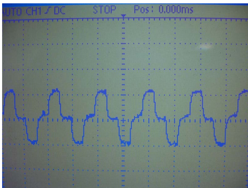
Figura 4.13 – Gráfico de corrente em uma das fases do motor de passo – modo meio passo.
