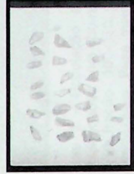
3400: Fração C composta por 24 cristais de zircões alongados entre 142 e 285 m, límpidos, obtidos na fração magnética M-5, sem hábito particular definido com cloração levemente esverdeada.
