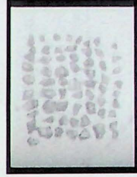
3401: Fração D composta por 65 cristais de zircões entre 71,5 e 214 m, os menores presentes na rocha, límpidos, obtidos na fração magnética M-5, sem hábito particular definido com cloração levemente esverdeada.
