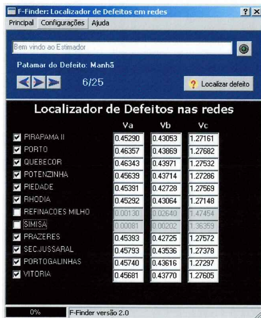
Figura 8.4 - Valores de Tensão (em pu) nos Pontos de Medição para uma Falta Dupla Fase em Refinações de Milho.
