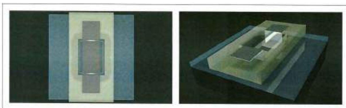
Figura 2.22: Vista superior e em perspectiva da amostra com contatos e filamento definidos.
