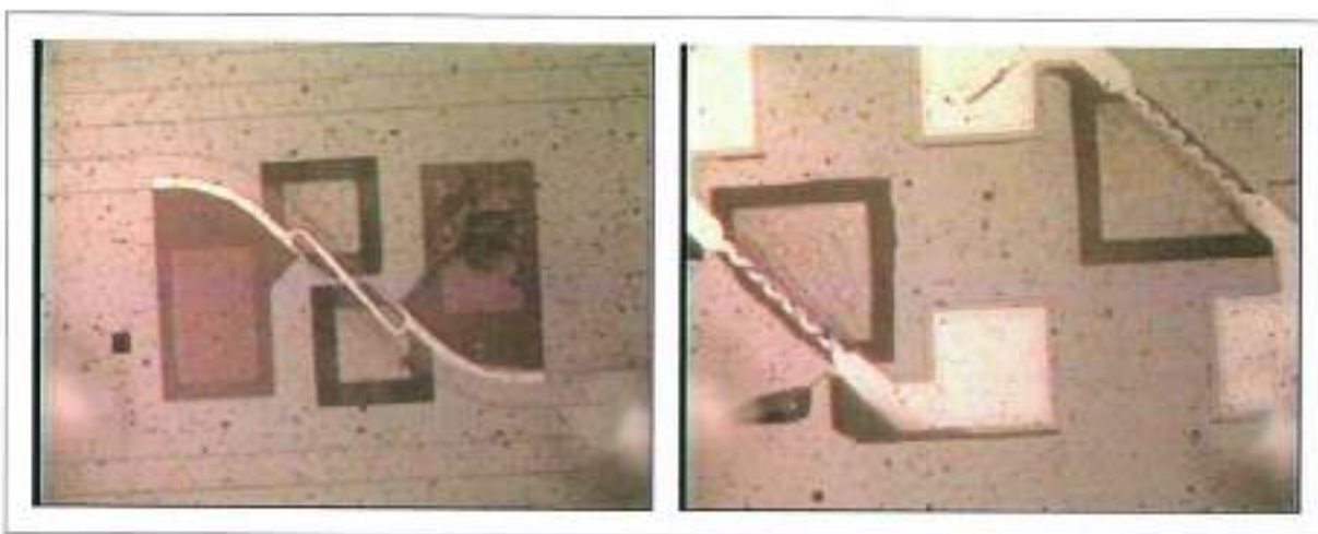
Figura 2.33: Fotos do aspecto final da corrosão por KOH para isolamento térmico por liberação das estruturas apenas nas áreas dos filamentos. À esquerda, tem-se o filamento perpendicular ao lado do triângulo condutor da corrosão e, à direita, o filamento foi projetado paralelo ao referido lado.
