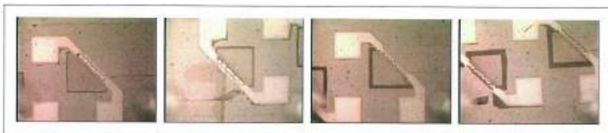
Figura 2.31: Fotos da evolução da corrosão por KOH para isolamento térmico dos filamentos
