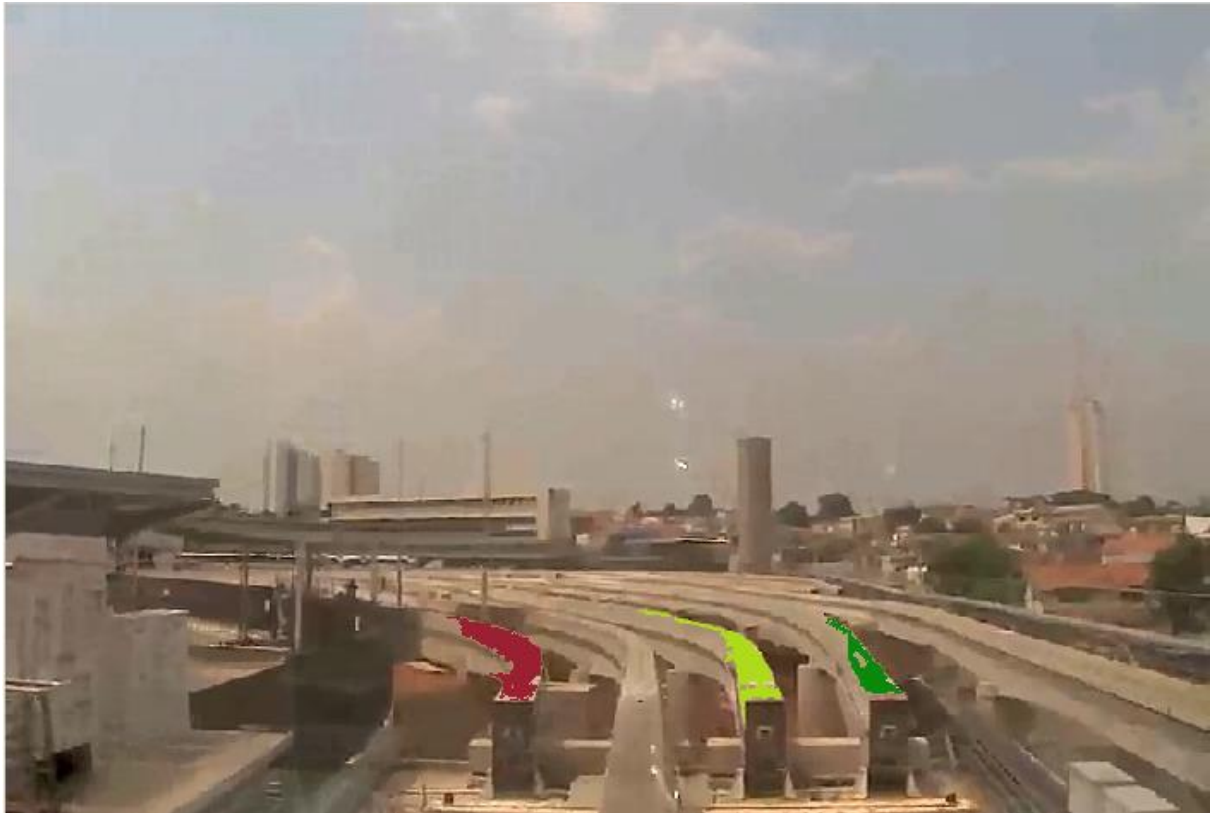
Figura 2.33 – Aplicação da técnica de preenchimento de região numa região de mudança de via no pátio Oratório – Linha 15.
