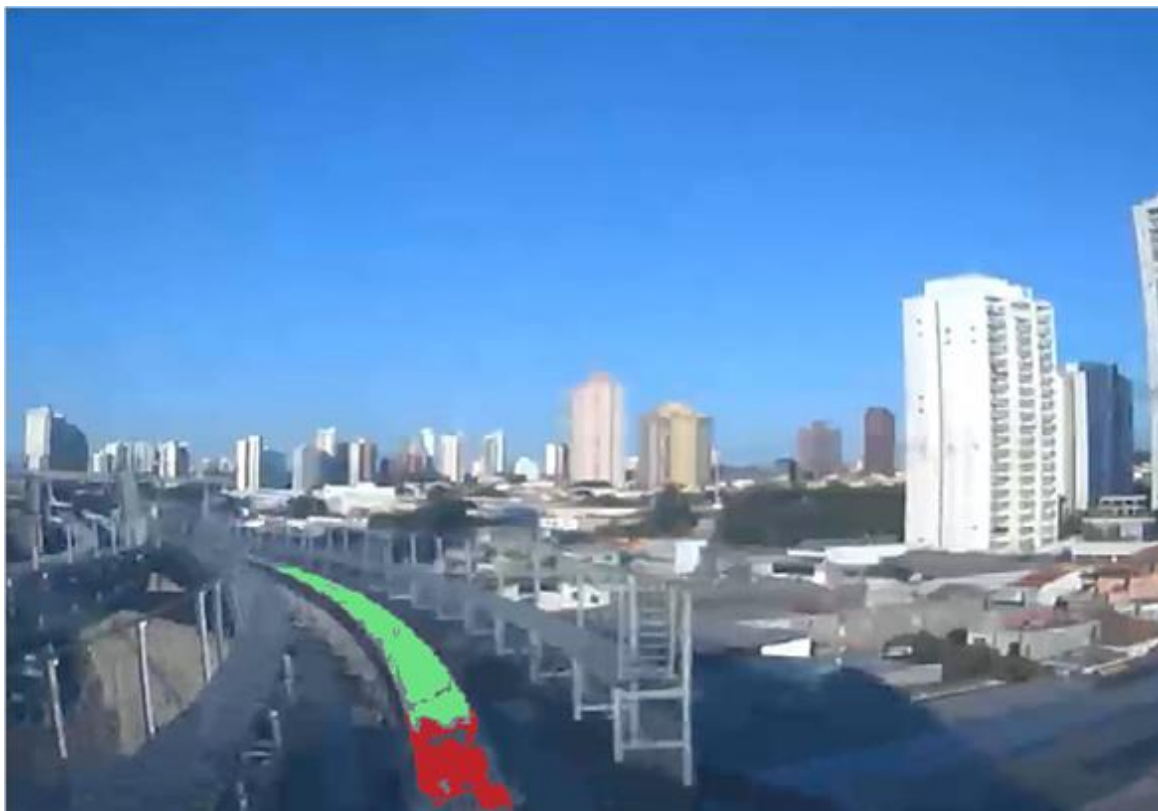
Figura 2.32 – Aplicação da técnica de preenchimento de região na primeira imagem de avaliação. A descontinuidade nas cores dos pixels, sobre a superfície da viga, segrega naturalmente a área.
