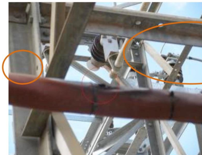
Tubo do RT perfurado em consequência do curto-circuito
