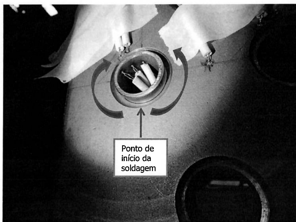
Figura 4.1 – Localização dos termopares, ponto de início e progressão da soldagem do "mockup".
