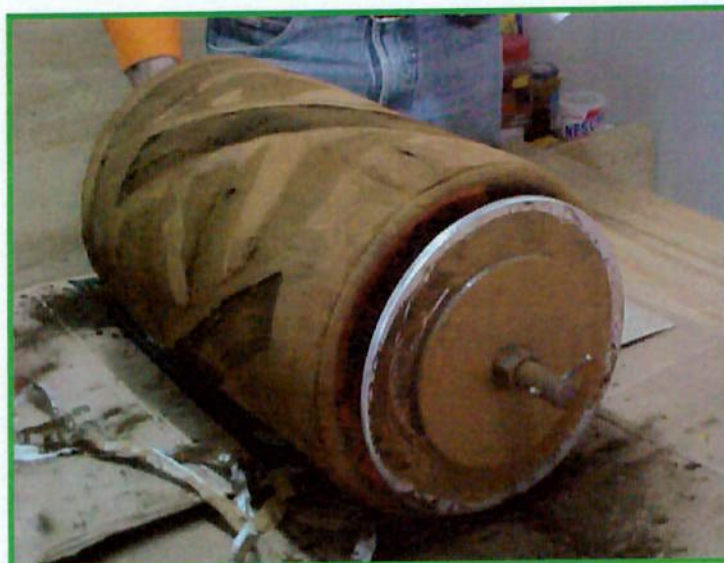
Figura 30 – “Pig” calibrador utilizado para verificar grandes reduções no diâmetro interno do gasoduto.
