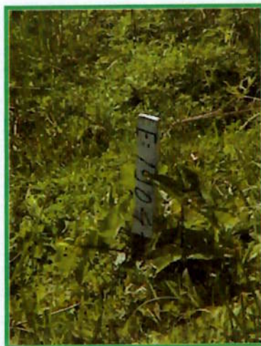
Figura 6 – Estaca Testemunha utilizada como marcador da faixa domínio.
