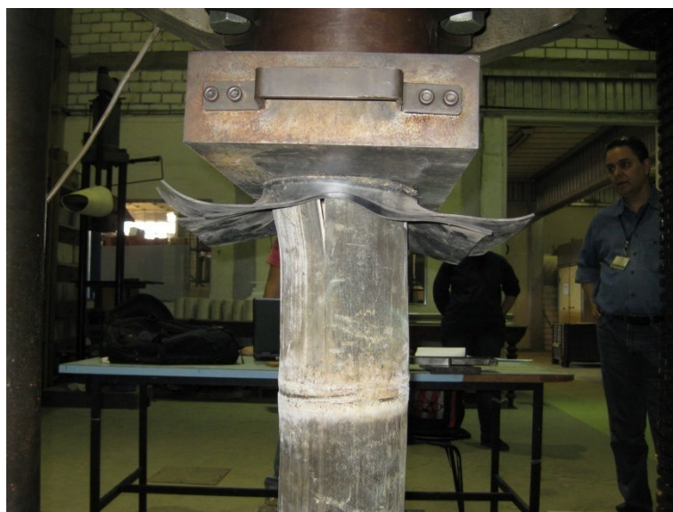
Figura 8 – Modo de ruptura do bambu a compressão
