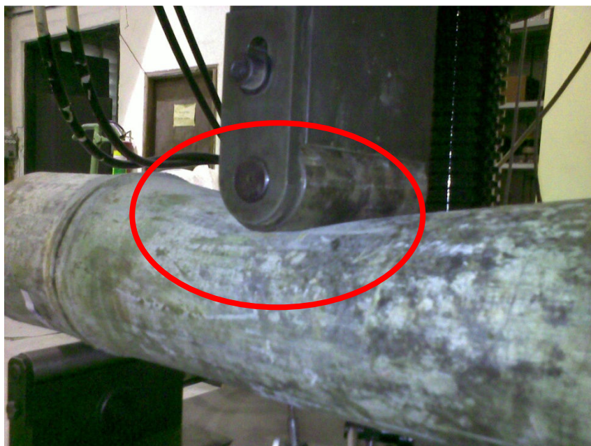
Figura 4 - Flexão localizada da parede superior do bambu no cutelo superior
