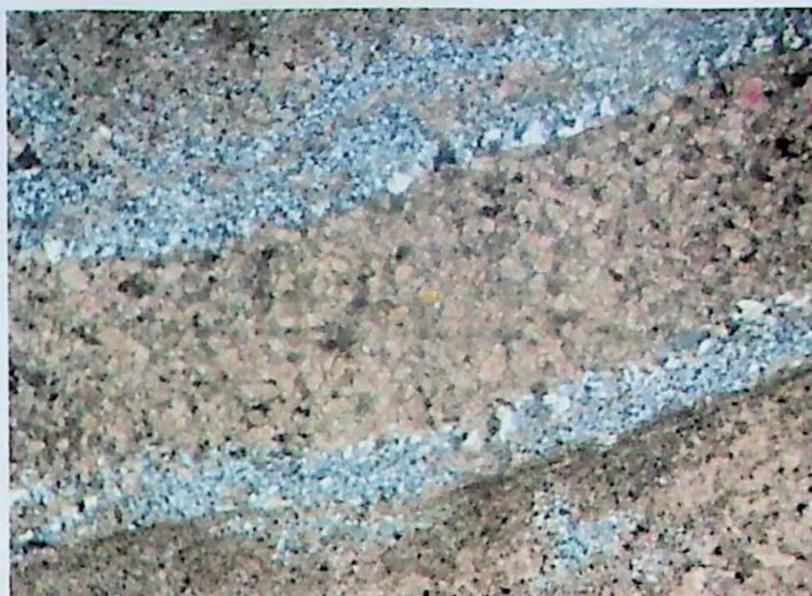
Foto 10. Rocha parcialmente recristalizada mostrando o bandamento composicional original S0
