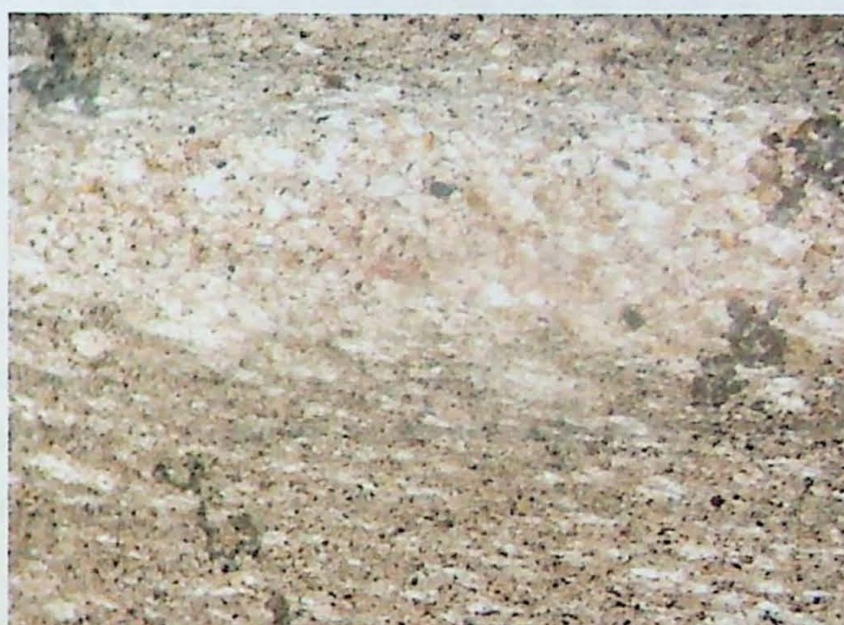
Foto 14. Filito com bandamento composicional de quartzo e filossilicatos apresentando forte orientação mineral
