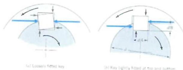
Fig. 39 – Chaveta submetida ao esmagamento (a) e ao cisalhamento (b)
