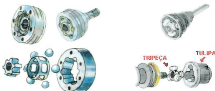
Fig. 70 – À Direita a junta homocinética VL e à esquerda a homocinética tripóide
