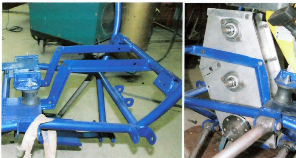
Fig. 59 – Suporte da caixa de transmissão 2004
