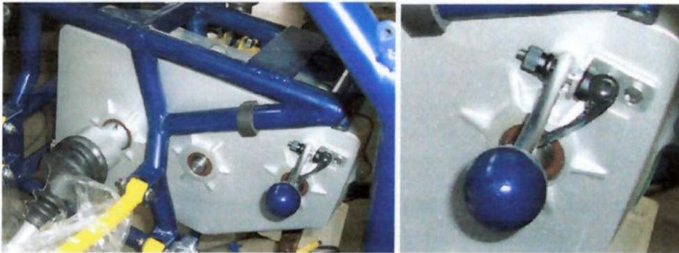
Fig. 69 – Travamento da posição da embreagem
