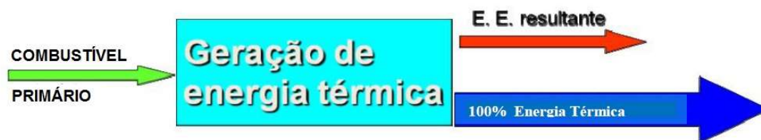
Figura 9 – Cogeração chamada Bottoming Cycle .
