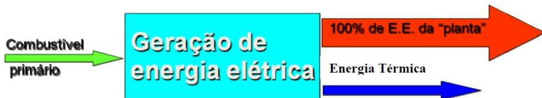
Figura 7 – Cogeração chamada Topping cycle .
