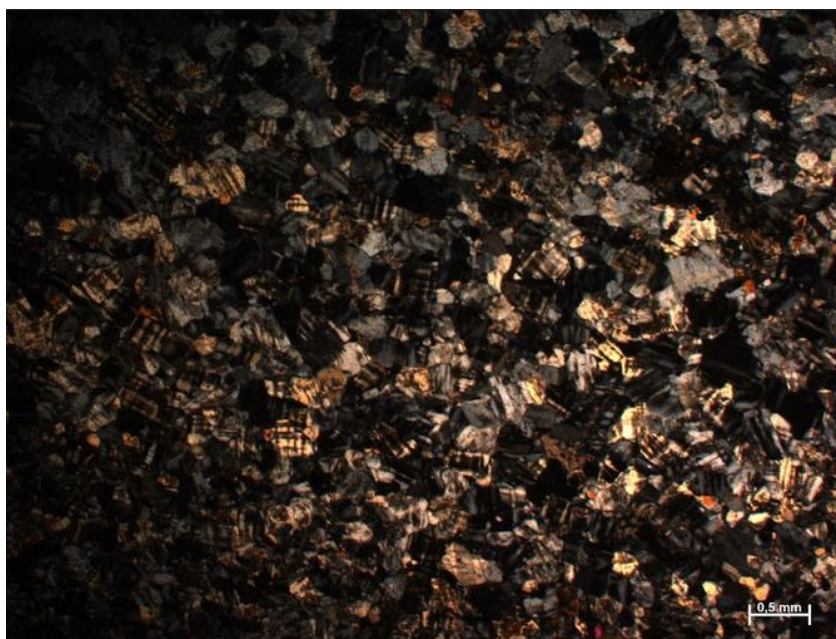
Figura 12: Fotomicrografia da textura granular do alcali quartzo sienito da lâmina GB01-C, sob polarizadores
