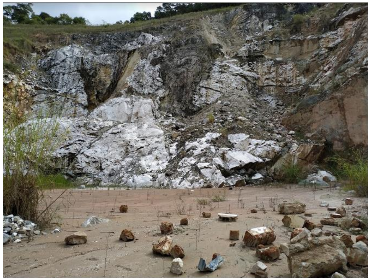
Figura 9: vista frontal da cava velha, o desnível de topo a base é de aprox 40m, com uma largura de aprox 80m, cobrindo atualmente uma área de aprox. 7500m 2 .
