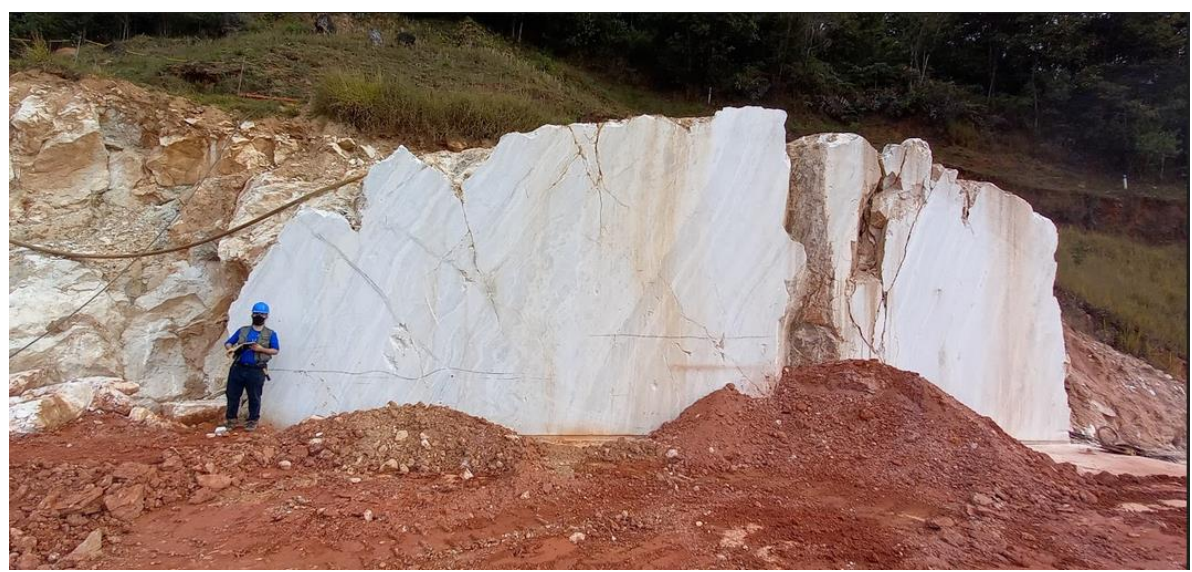
Figura 18: Foto da bancada superior (de 3 bancadas em atividade) da cava nova. Humano de escala possui 1,73m de altura.
