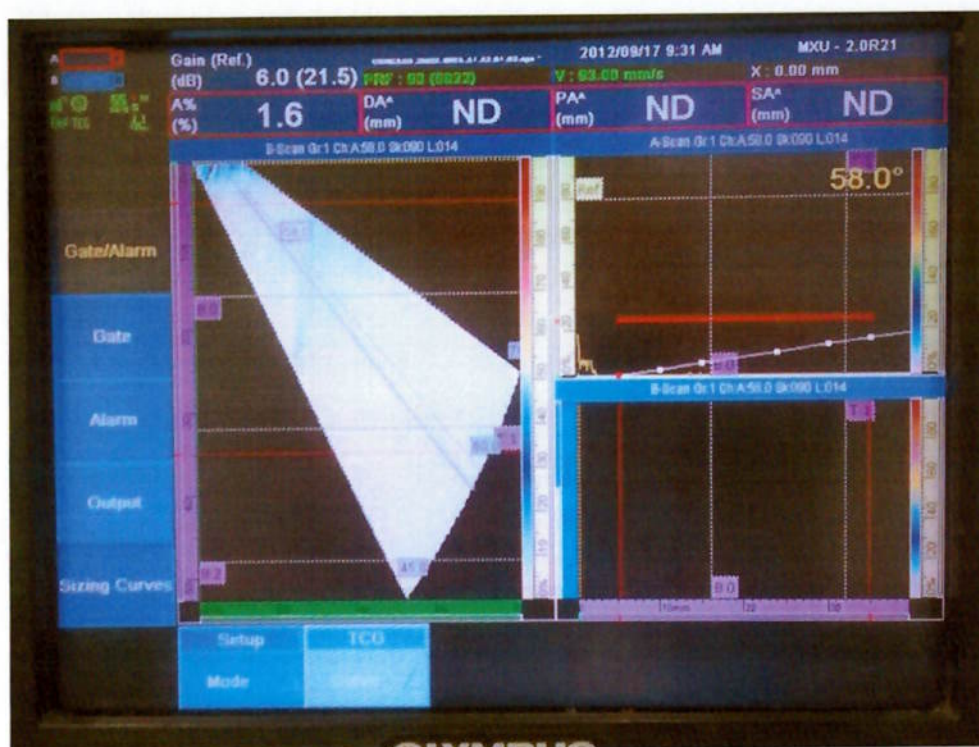
Figura 5-24 – Curva TCG aço inoxidável
