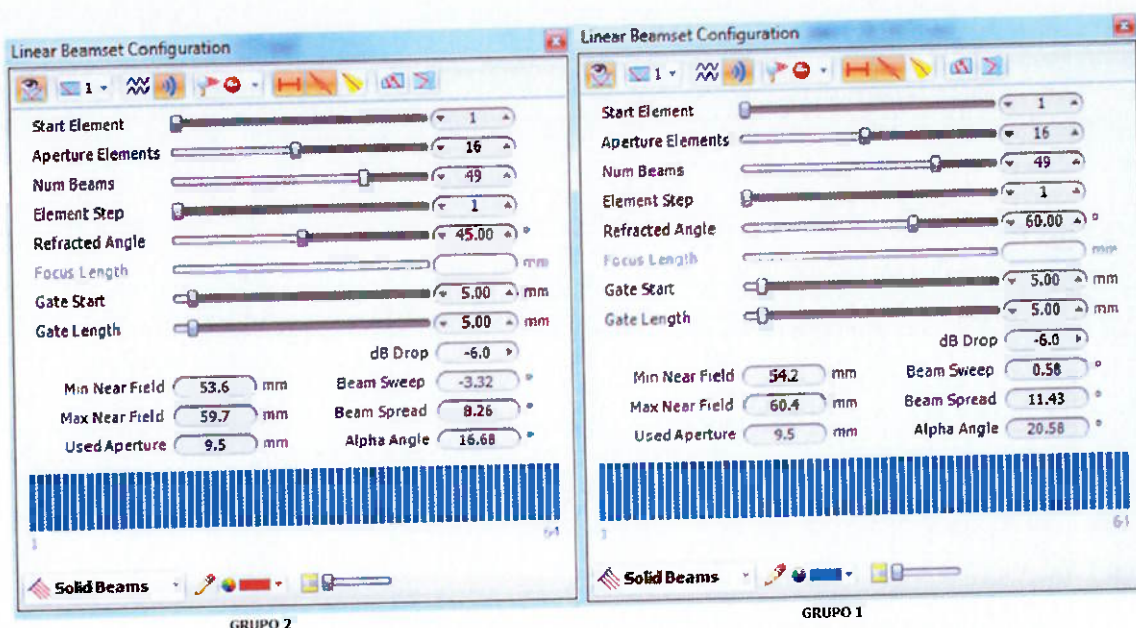
Figura 5-7 – Dados do feixe sônico para varredura linear com ângulo fixo.
