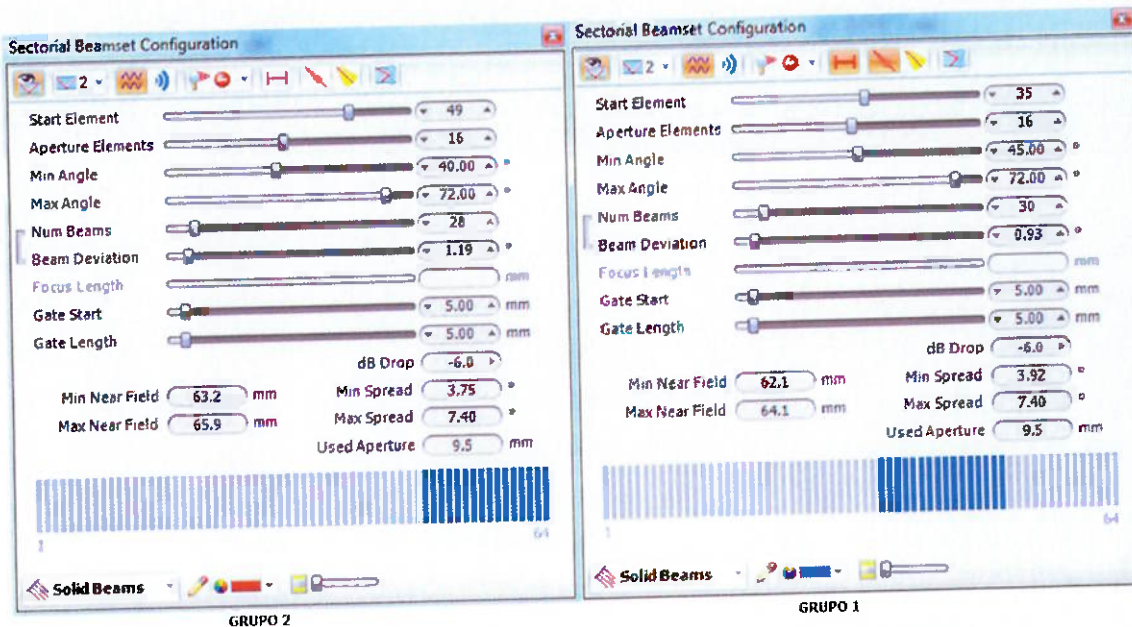
Figura 5-6 – Dados do feixe sônico para varredura setorial.
