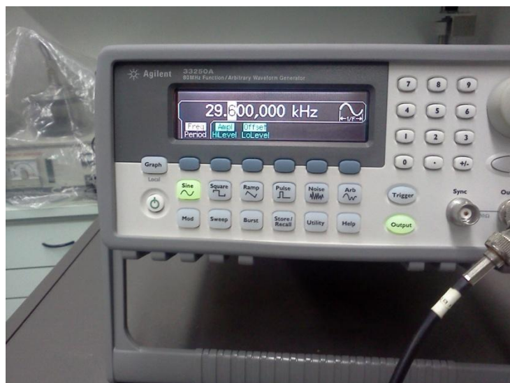
Figura 50 Gerador de funções ajustado com onda senoidal de frequência 29,6 kHz
