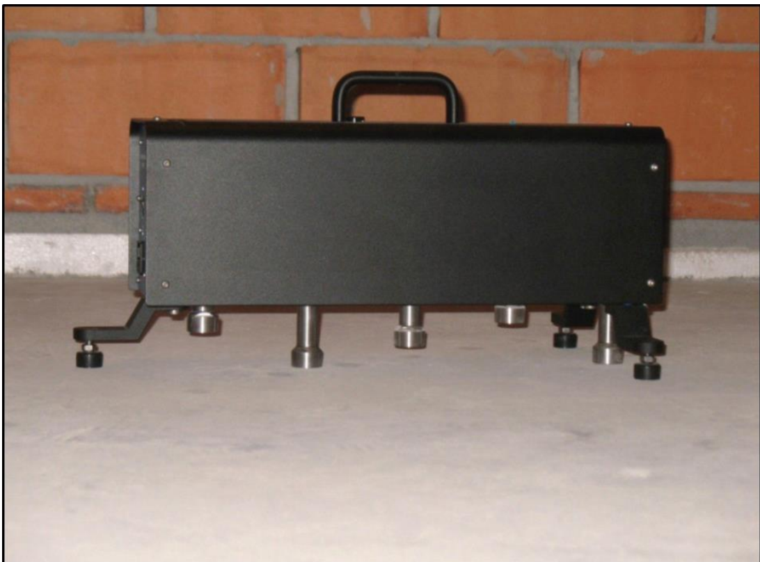
Figura 10: Equipamento padronizado para ensaios de ruídos de impacto em pisos
