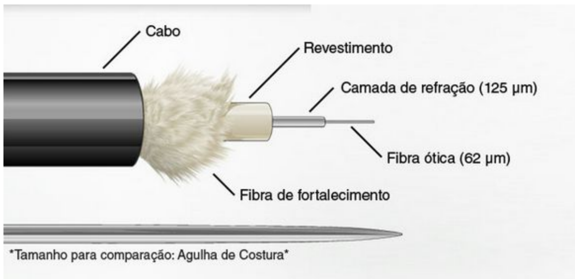
Figura 1. Estrutura da fibra óptica e suas dimensões. [10]
