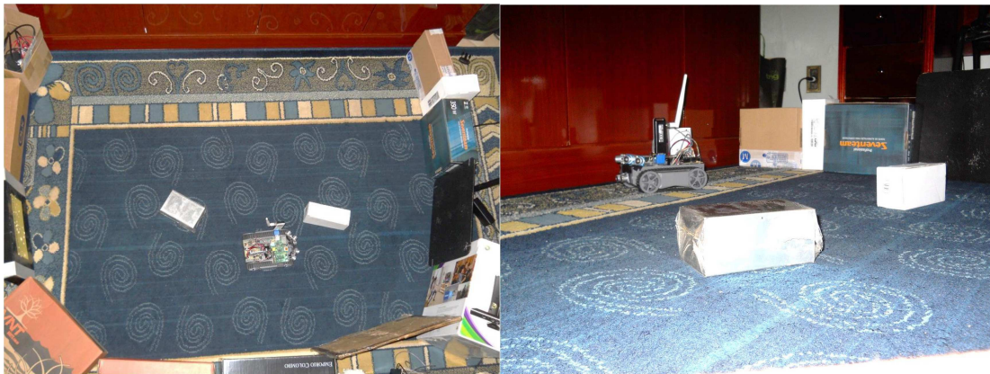
Figura 4.11. Ambiente real de testes improvisado com caixas e dois obstáculos retangulares para testes do sistema de navegação (vista superior e lateral).
