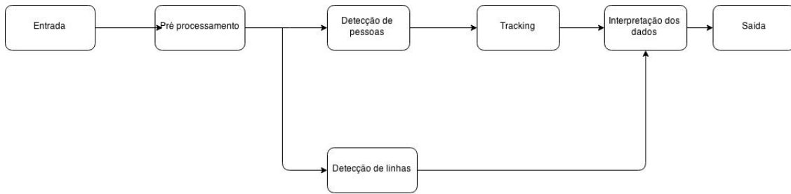
Figura 3.1: Diagrama de blocos que rege o desenvolvimento do sistema.
